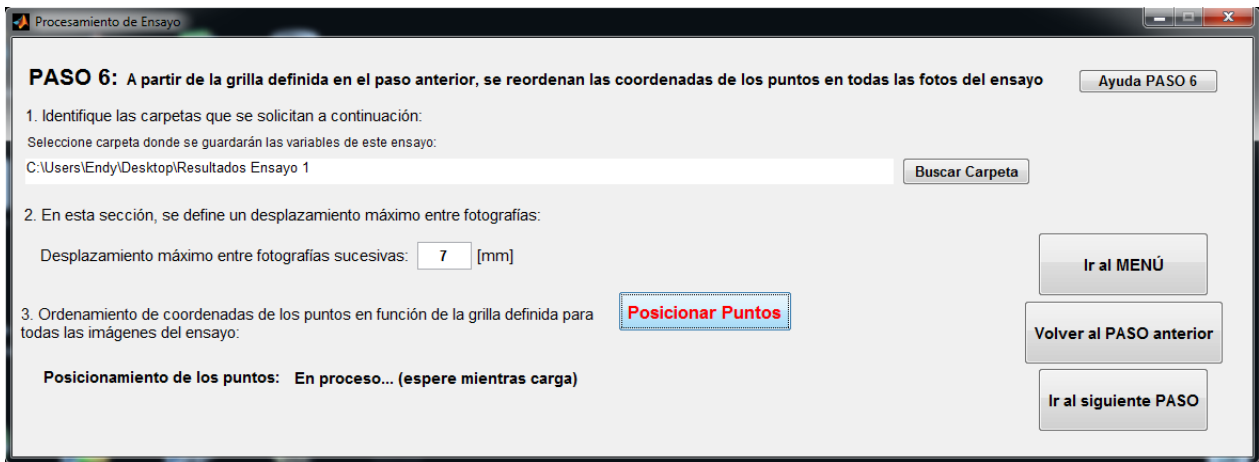
Figura 67. Interfaz gráfica de PASO 6 (Posicionamiento de puntos del resto de las imágenes)
