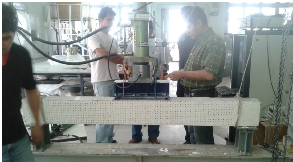
Figura 34. Preparación y calibración del sistema de carga
