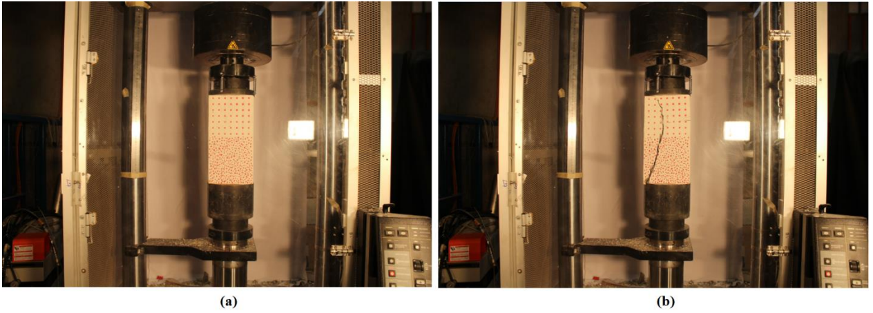
Figura 53. Ensayo en probetas de Grupo 2: (a) Situación inicial; (b) Situación final
