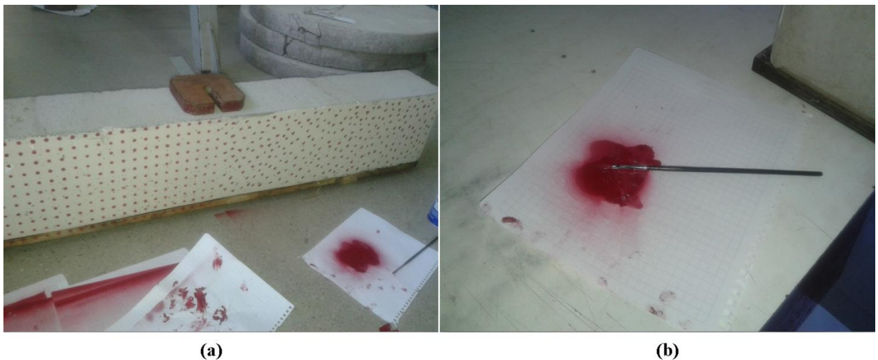
Figura 38. (a) Sistema de referencia doble; (b) Pincel ocupado para realizar manchado
