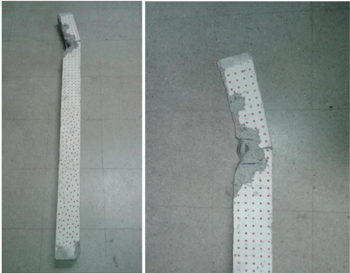
Figura 46. Falla por flexo-compresión en Columna larga
