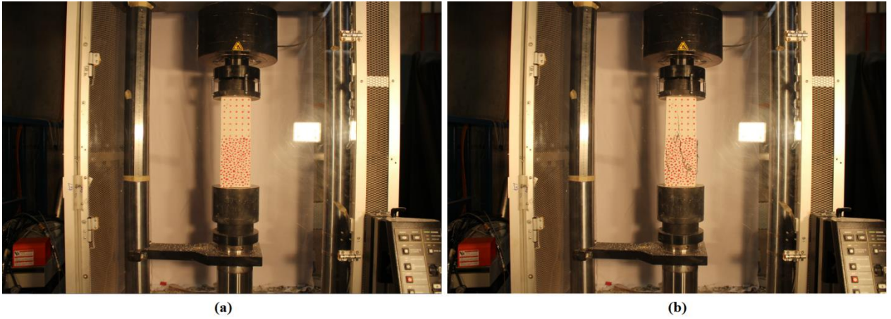
Figura 52. Ensayo en probetas de Grupo 1: (a) Situación inicial; (b) Situación final
