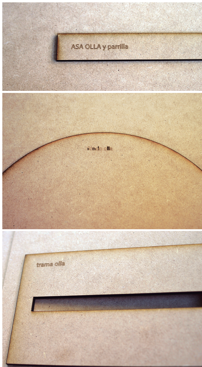
Moldes en MDF 3 mm cortados en láser.
