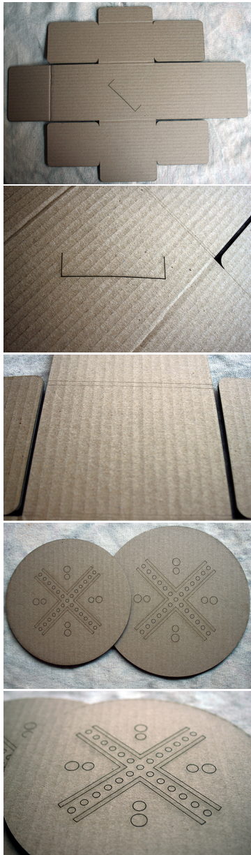
De arriba a bajo. Original caja. Detalle lengüeta inferior del contenedor. Detalle troqueles de pliegue. Amortiguadores intermedios. Detalle grabado amortiguador.
