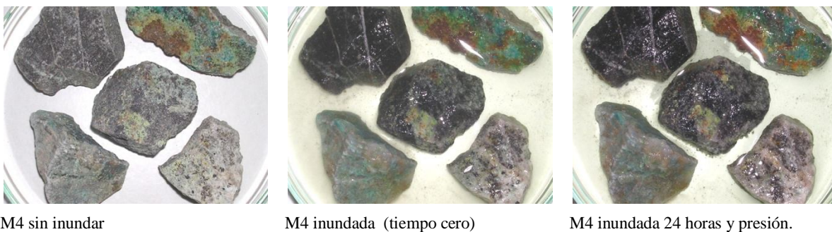
Figura 5.15: Muestra M4 de granulometría 3/4" inundada con refino.
