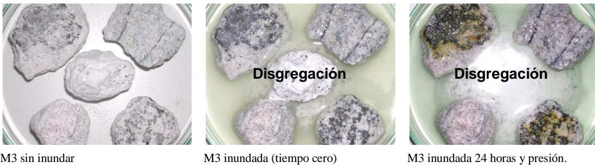
Figura 5.13: Muestra M3 de granulometría 3/4" inundada con refino.
