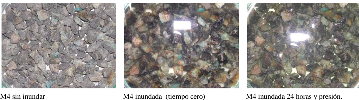
Figura 5.16: Muestra M4 de granulometría 4# inundada con refino.
