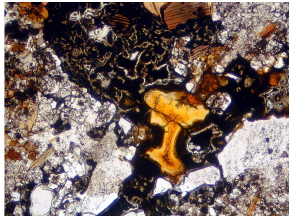
Figura 5.8: M4. Vetilla de crisocola parda con fases de Cobre Negro. Luz transmitida. Nic. // (5x10).
