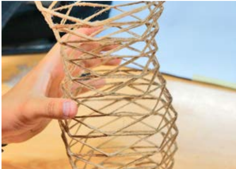
Imagen 69: Fibra curada con la forma final, A. Vidal, 2014
