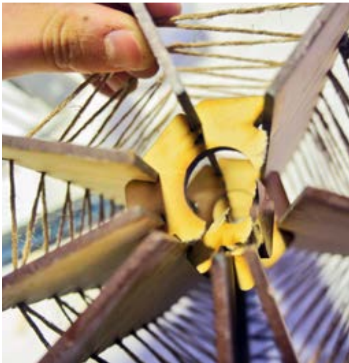
Imagen 81: Mediante el desarmado la galleta se debió romper, A. Vidal, 2014
