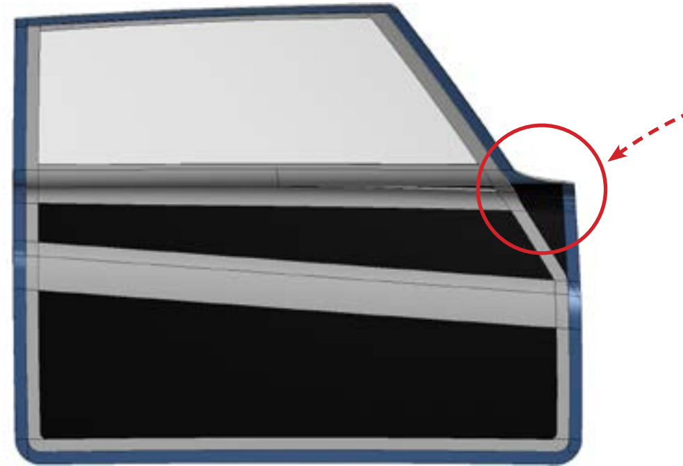
Imagen 122: Interior de la puerta con detalles de la ubicación de los núcleos de compuesto sándwich, A. Vidal, 2014
