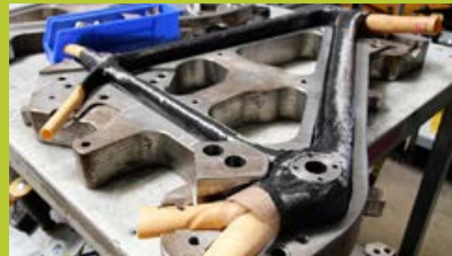
Imagen 21: Cuadro de bicicleta moldeado por vejiga en fibra de carbono, Hi-Torque Publications Inc. 2013
