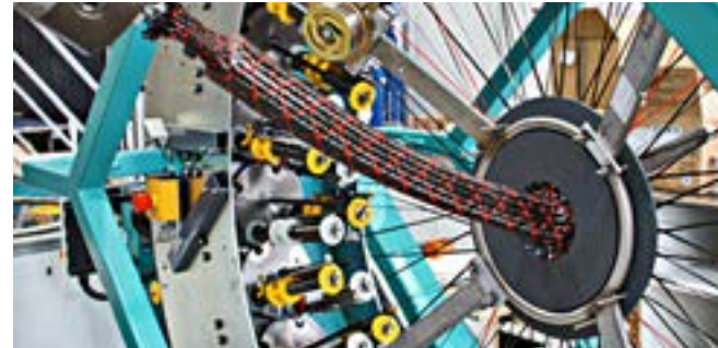
Imagen 15: Proceso automatizado de trenzado de filamentos 1. Munich Composites GmbH 2014
