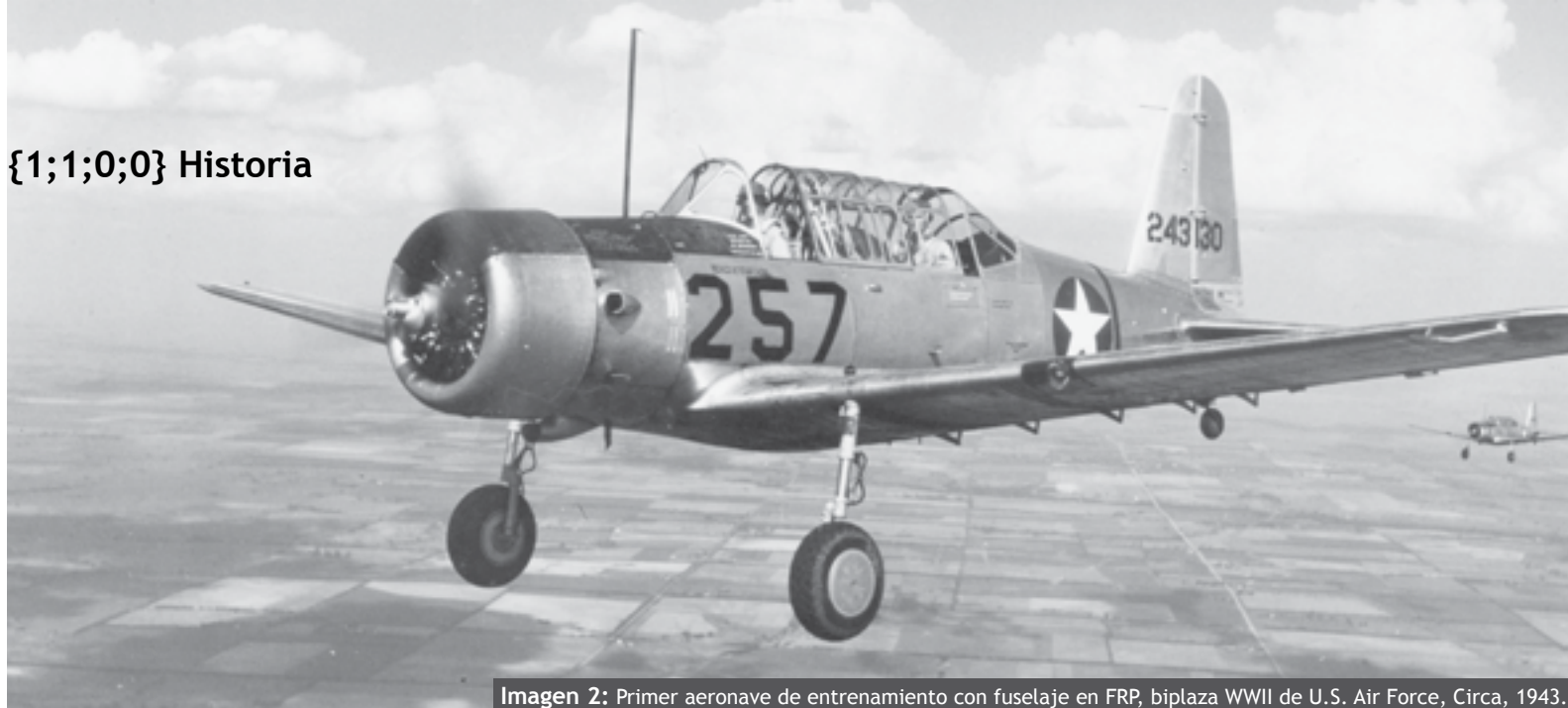
Imagen 2: Primer aeronave de entrenamiento con fuselaje en FRP, biplaza WWII de U.S. Air Force, Circa, 1943.
