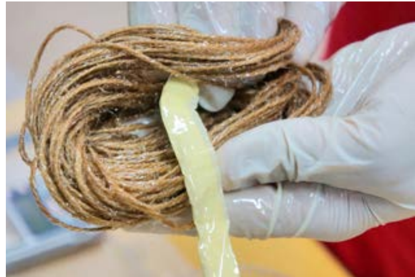
Imagen 68: Hilo de yute recién impregnado con resina epoxi, A. Vidal, 2014
