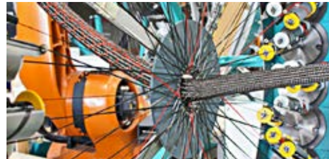
Imagen 16: Proceso automatizado de trenzado de filamentos 2. Munich Composites GmbH 2014.
