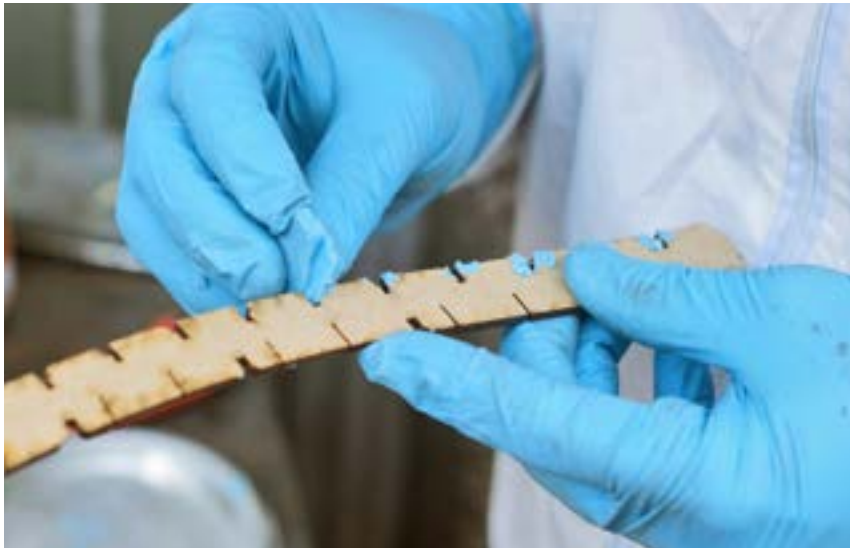
Imagen 90: Aplicación de cera desmoldante, A. Vidal, 2014
