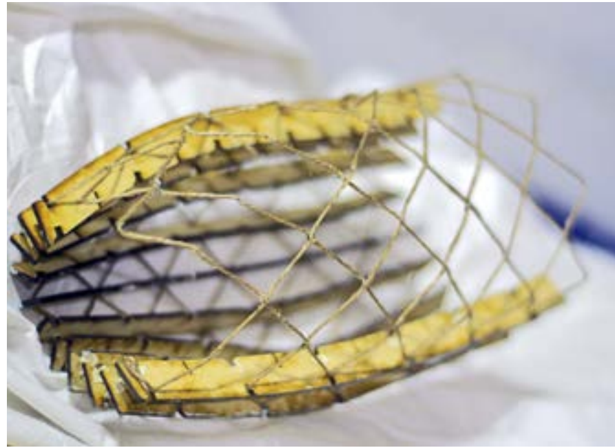
Imagen 94: Fallo producto de exceso de cera desmoldante, A. Vidal, 2014
