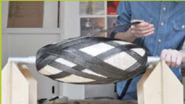
Imagen 20: Proceso de envoltura de mandril manual con cintas de fibra de carbono en seco, para luego realizar proceso de infusión con bolsa de vacío. Smoothy Ltd. 2013
