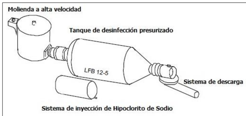
Figura 15: Sistema de tratamiento químico de Hipoclorito de Sodio [9].
