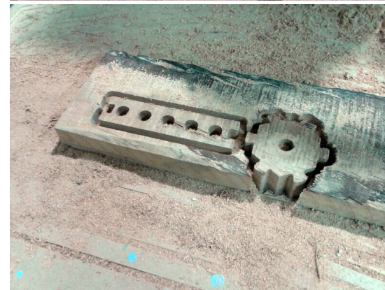
Imagen 9o. Detalle durante el frezado de las piezas estructurales
