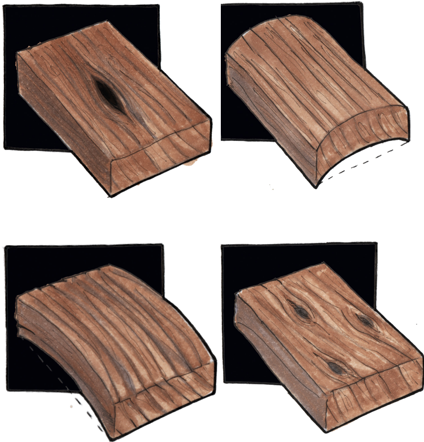
Imagen 31. Principales defectos de la madera. De arriba hacia abajo: Nudo vivo, hendidura, nudo muerto, abarquillado, retorcimiento y nudo en grupo.
