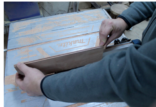
Imagen. Detalle del proceso. Corte de tablas para la obtención de láminas de madera.
