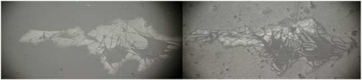
FIGURA 3.9: CAMBIOS PRESENTES EN LA SUPERFICIE PARA UNA MISMA ZONA, ENTRE (A) PRIMER COATING ; Y (B) SEGUNDO COATING . DESTACA LA PROPAGACIÓN DE GRIETAS PRESENTES EN (A) Y LA APARICIÓN DE OTRAS NUEVAS
