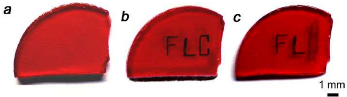
FIGURA A.5: (A) MUESTRA DE NANOCOMPUESTO DE COBRE/SÍLICE; (B) ESCRITURA CON LÁSER SOBRE EL NANOCOMPUESTO; (C) BORRADO CON LÁSER [22]
