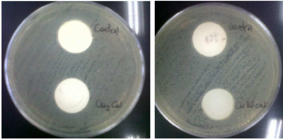
FIGURA 3.25: ESTADO FINAL EN LAS PRUEBAS DE HALO INHIBITORIO; EN LA PARTE SUPERIOR SE OBSERVAN LAS MUESTRAS DE CONTROL, Y ABAJO LAS MUESTRAS CON COBRE. IZQUIERDA: SINTETIZADA POR Cu_2 ; DERECHA: SINTETIZADA POR Cu_{10} . NINGUNA PRESENTA DIFERENCIAS CON EL CONTROL.
