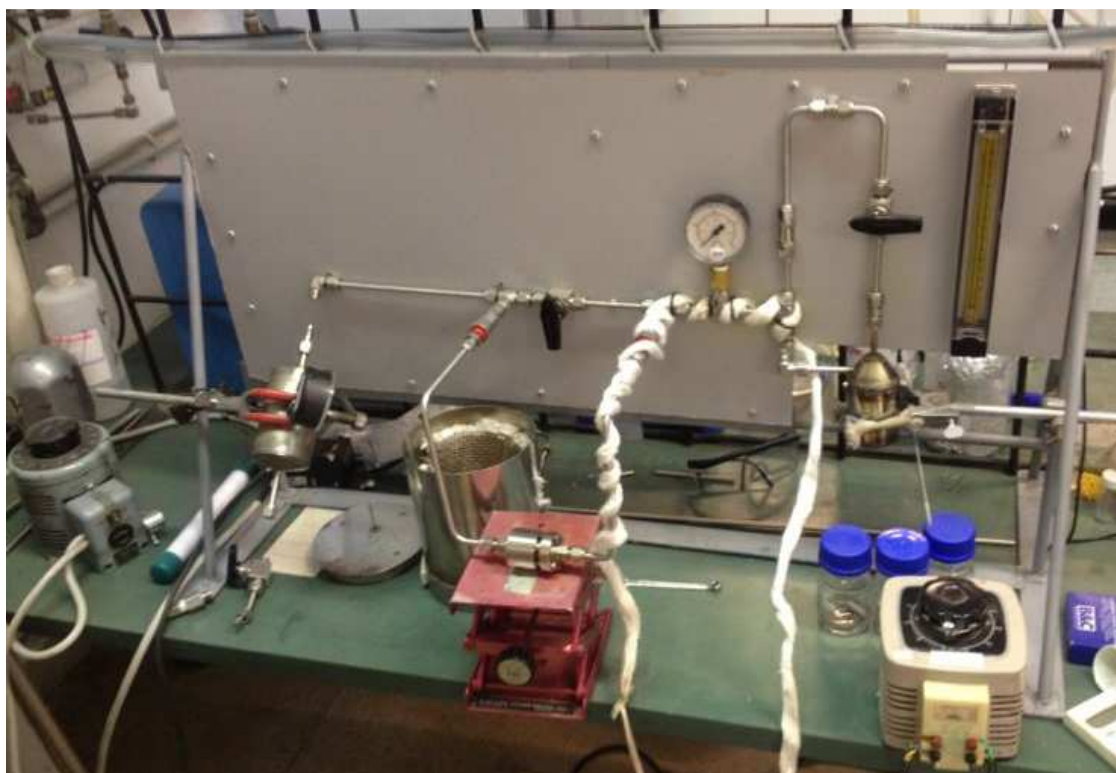
FIGURA 2.6: INSTALACIÓN DEL SISTEMA DE REACCIÓN EN EL LABORATORIO DE POLÍMEROS
