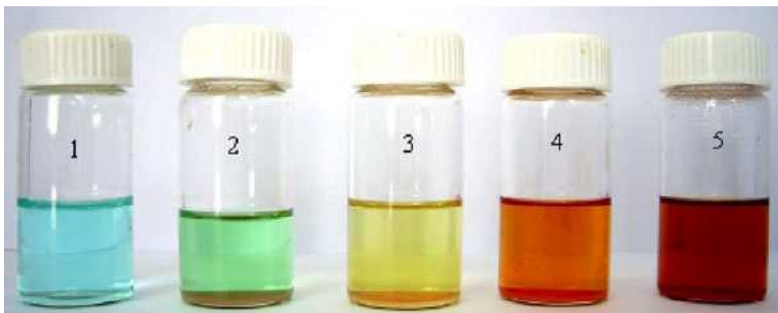
FIGURA 1.11: ETAPAS DE REDUCCIÓN DE NANOPARTÍCULAS DE COBRE EN SOLUCIÓN ACUOSA [25]
