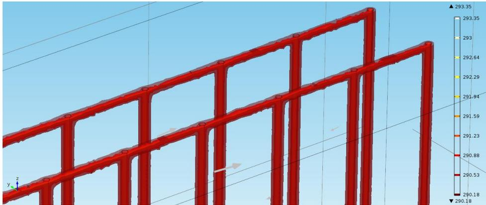
Figura 5.70: Contornos isotérmicos del sistema de dos líneas de 10 sondas en serie luego de un día (86.400[s]) de funcionamiento, acercamiento a zona media y de salida del fluido en ambas líneas.
