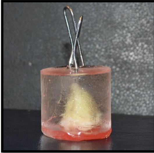
Fig. 4: Cilindro de resina epóxica con tercer molar incluido.
