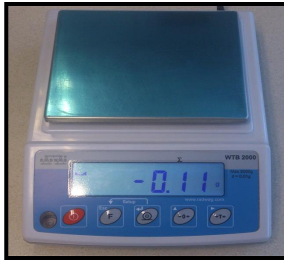
Fig. 7: Balanza digital de precisión RADWAG WT2000®.
