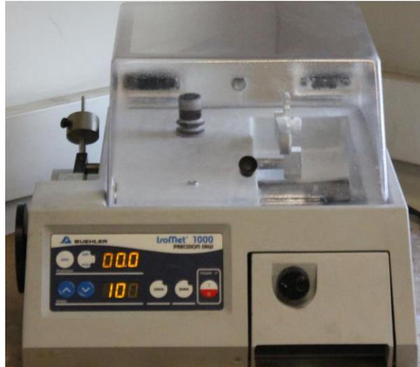
**Fig. 6.** Sierra de baja velocidad Isomet 1000 (Isomet Buehler Ler Lakebuff IL. USA 1000)
