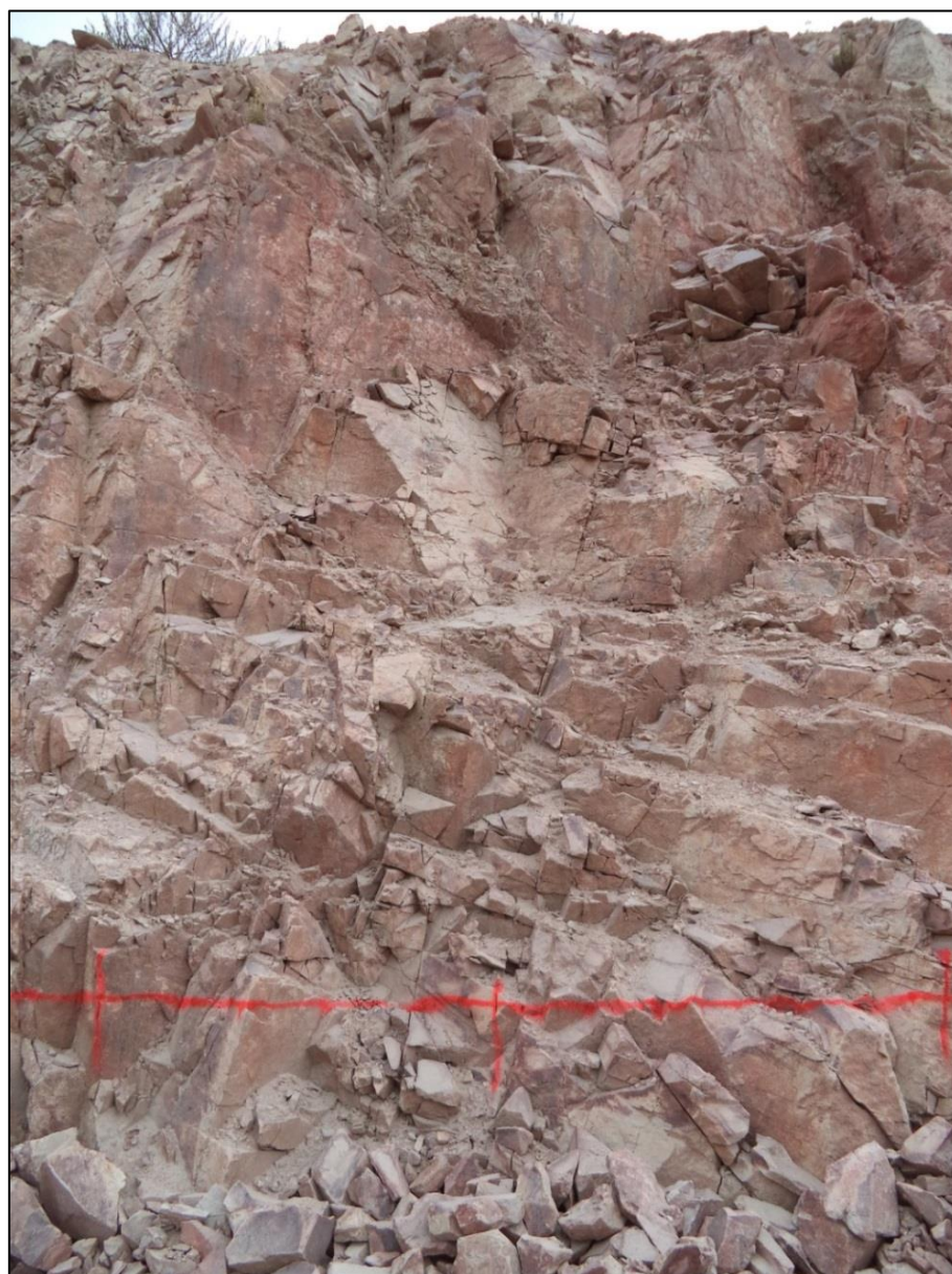
Figura 3. 1: Línea de detalle en la cara del banco 3, entre los metrajes 36-40. Los marcadores verticales están espaciados cada 2 m. La altura del banco es de 15 m (imagen con distorsión angular debido a la cercanía con la cara del banco).
