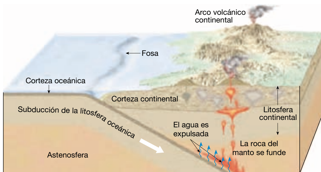
Fig. 1: Formación de arco volcánico en zona convergente de placas tectónicas. Fuente: Tarbuck & Lutgens, 2005.
