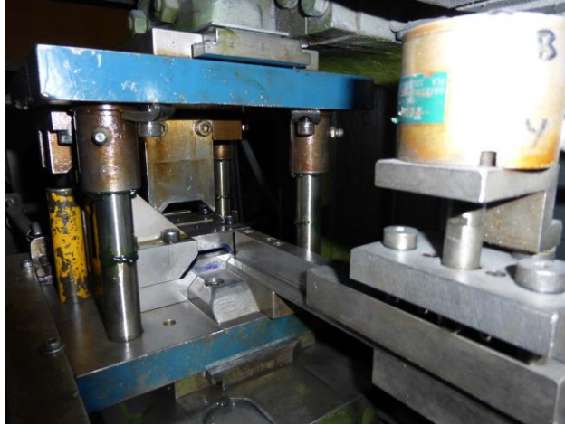
Figura 5.13: Biseles para una mejor salida de la pieza
