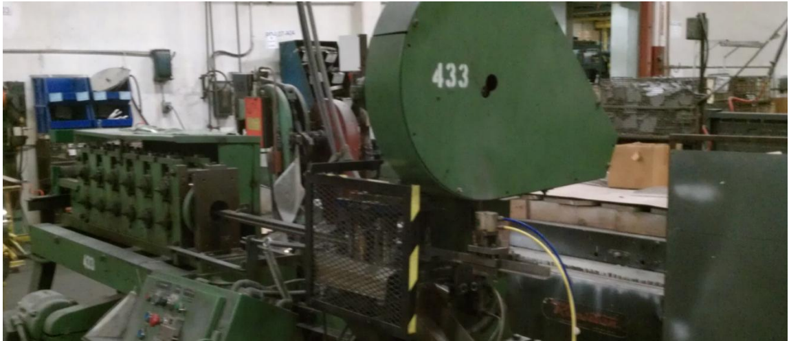
Figura 1.1: Máquina de Rodillos Formadores, Prensa y salida de la pieza
