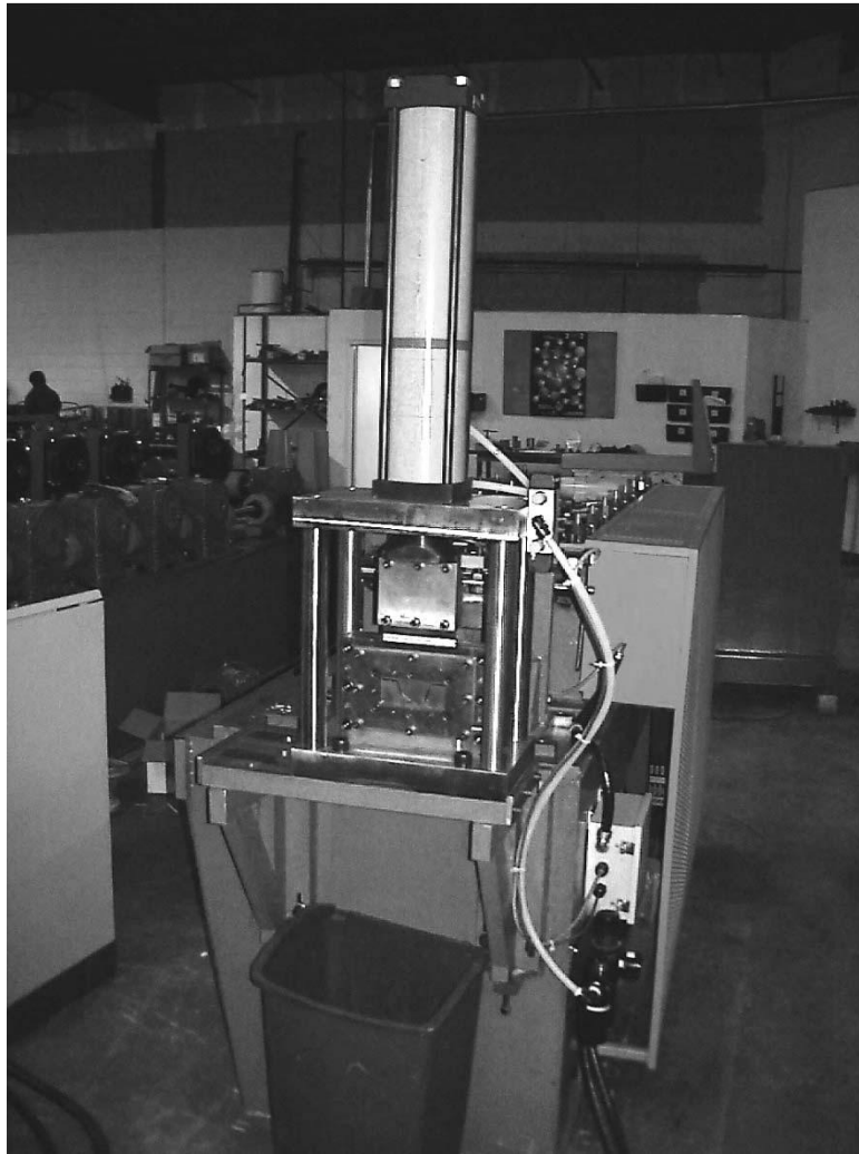
Figura 3.11: Prensa de cilindro neumo-hidráulico
