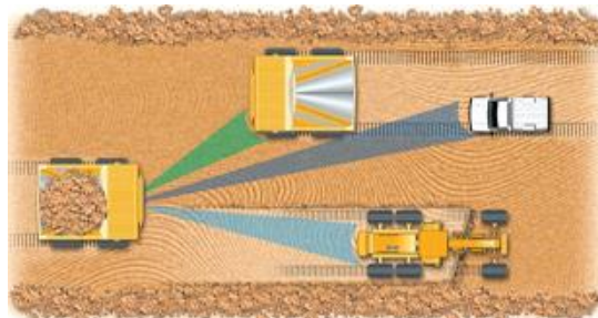
Figura 14. Sistema de detección de obstáculos.
