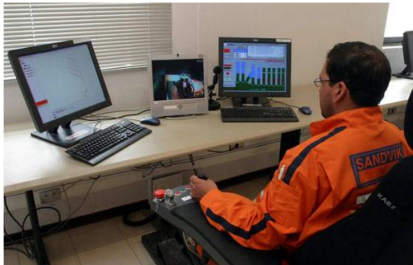
Figura 12. Sala de control LHD autónomos.
