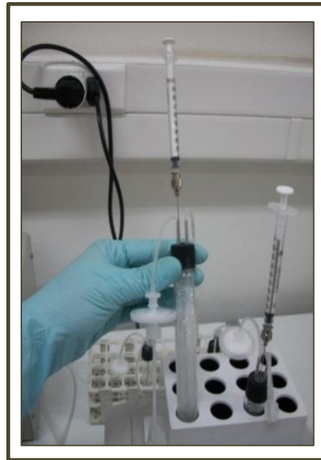
Figura 5. Fotografías de los mini-fermentadores con ácidos grasos y tritón X-100 para cultivo de cepas de E. coli a 46RPM y 37°C.
