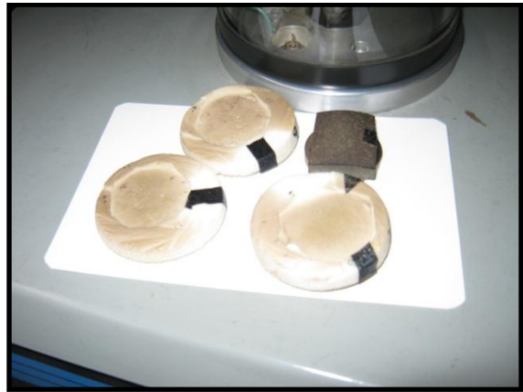
Figura 20. Replicas de piezas arqueológicas y muestra de control analizadas con el MEB.
