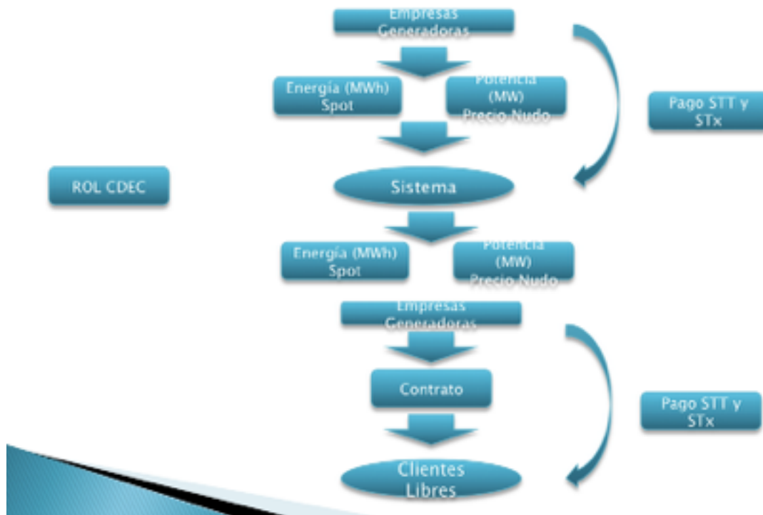
Figura N° 2 “ Cadena de compra y venta de energía en el sistema” Fuente elaboración propia.
