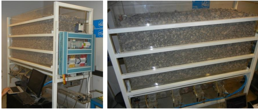
Figura 3.4. Modelo físico construido para este trabajo de investigación: (Izquierda) Modelo físico con panel eléctrico y de actuación; (Derecha) Perspectiva del modelo físico cargado con material
