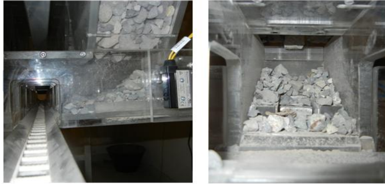
Figura 4.1. Colgadura presenciada en Experimento 2.1: (Izquierda) Vista desde costado de batea y galería Dozer; (Derecha) Vista frontal del punto de extracción
