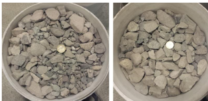
Figura 3.26. Muestras de las granulometrías utilizadas: (Izquierda) Granulometría G1, d_{50}=15,9 mm; (Derecha) Granulometría G2, d_{50}=19,4 mm
