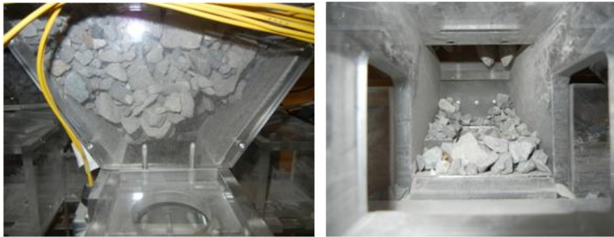
Figura 4.2. Colgaduras en puntos de extracción: (Izquierda) Vista posterior de colgadura a nivel de batea en punto de extracción; (Derecha) Vista frontal de colgadura a nivel de batea en punto de extracción
