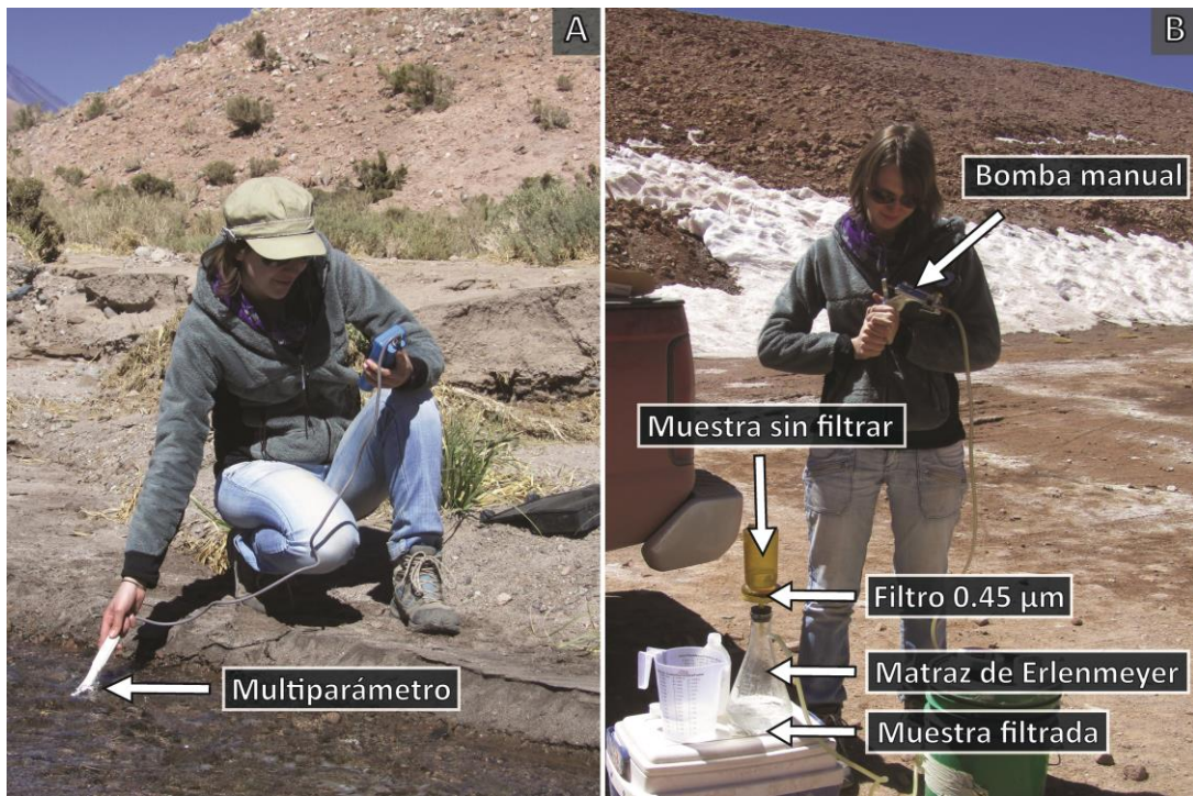
Figura III.5. (A) Medición in situ de temperatura, pH y conductividad eléctrica en muestras de agua. (B) Procedimiento de filtrado.
