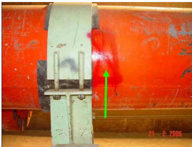
Figura 7.1.4: Pieza 24-ESW-014 con desgaste
