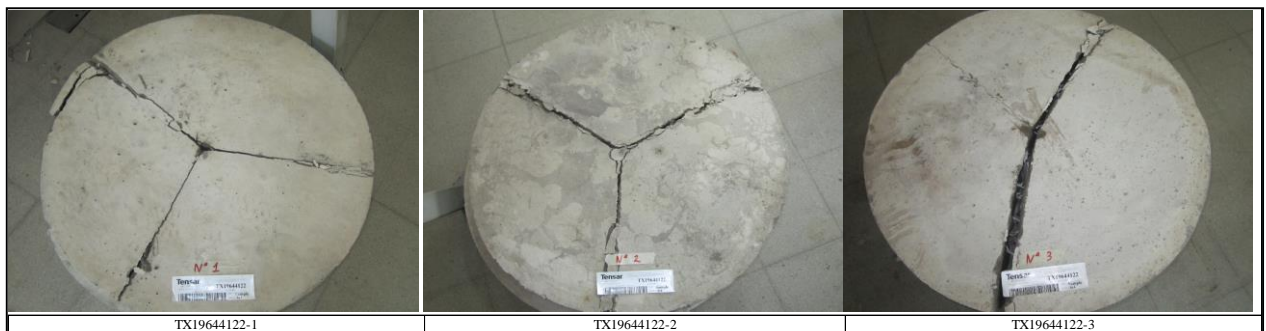
Figura 19: Modo de Falla Datos Experimentales Refuerzo Malla TX196-2.
