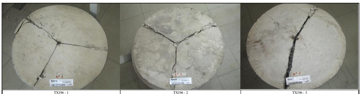
Figura 17: Modo de Falla Datos Experimentales Refuerzo Malla TX196-1.
