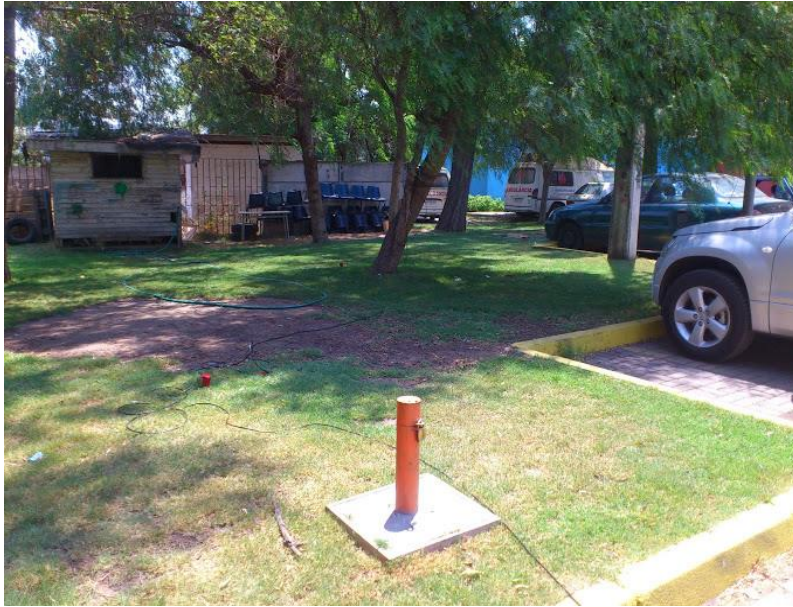
Figura 4-1: Disposición en terreno de ensayo MASW en Maipú
