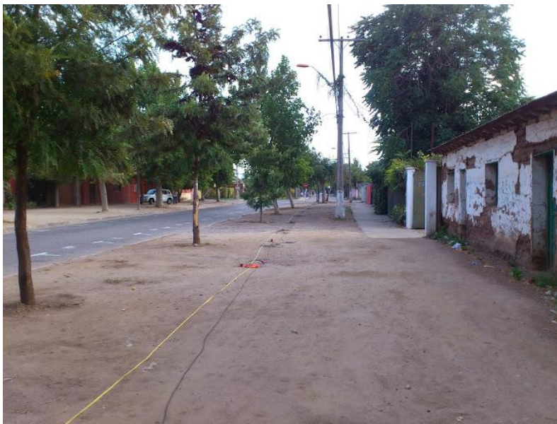
Figura 4-13: Disposición en terreno de ensayo MASW en Melipilla
