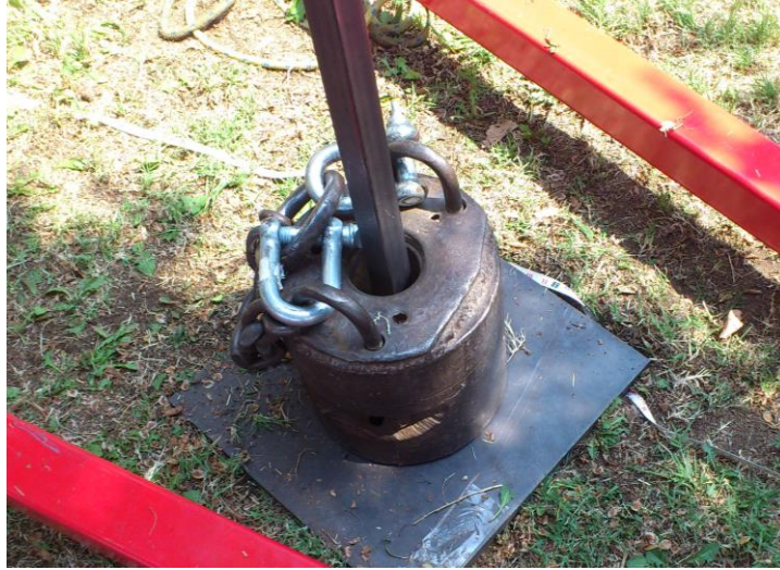
Figura 3-15: Masa de ensayo SPT utilizada en las mediciones.
