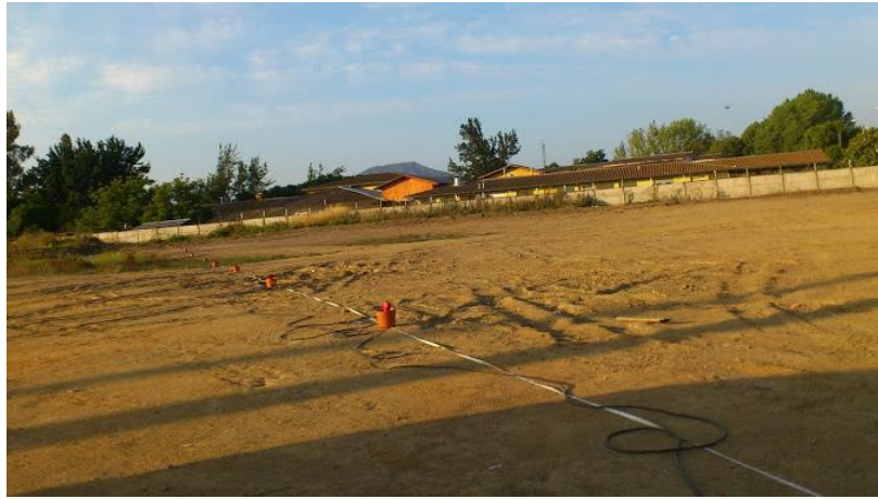
Figura 4-9: Disposición en terreno de ensayo MASW en Casablanca
