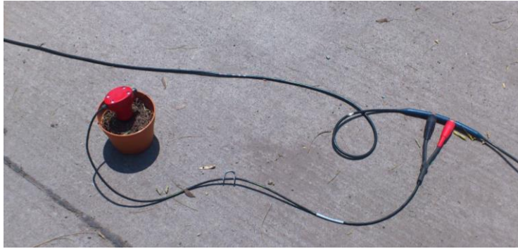
Figura 3-13: Geófono vertical utilizado
