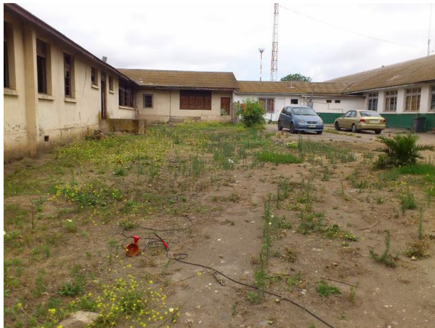
Figura 4-17: Disposición en terreno de ensayo MASW en Lolleo
