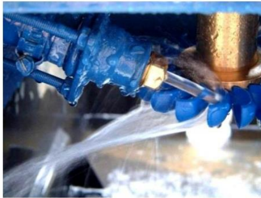
Figura 2-1: Jet inclinado de una turbina Turgo [3].
