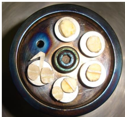
Figura 8. Muestras montadas en Sputter para recibir baño oro-paladio
