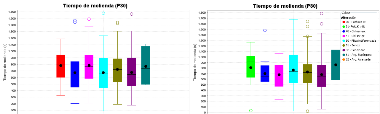
Figura 28: Tiempo de molienda. (Izq.) Andesita. (Der.) Pórfido Feldespático, distribuidos por alteración.
