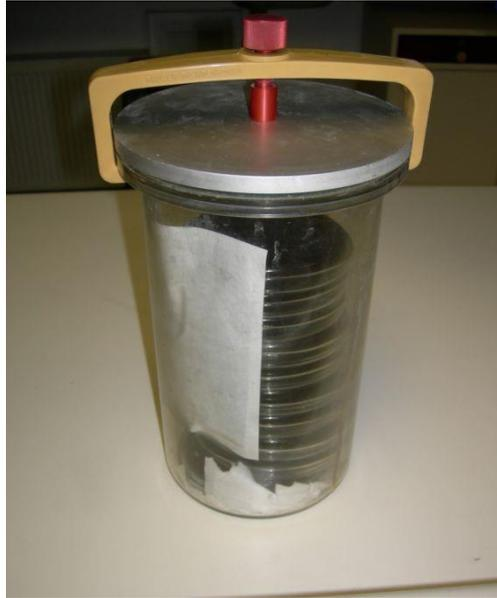
Fig. 19: Placas sembradas almacenadas en jarra de anaerobiosis
