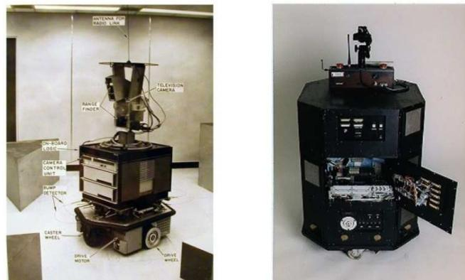
Figura 2. Robots Shakey (izq.) y Flakey de SRI (der.).
