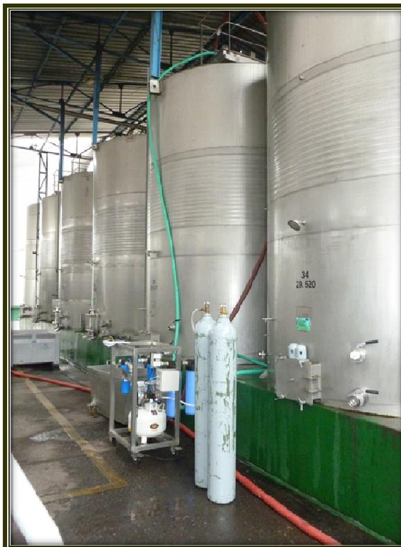
**Figura 5:** Proceso de extracción del gas de fermentación.
