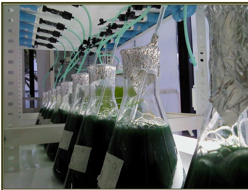
**Figura 2:** Organización de los cultivos de *Arthrospira platensis* en donde se aprecia el sistema de inyección de aire enriquecido con  $\text{CO}_2$  y la fuente lumínica.
