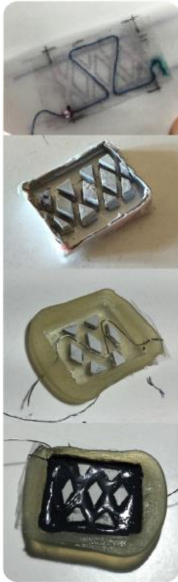
Fuente: Elaboración propia. Variaciones de recorrido de cableado interno del dispositivo de sensado
