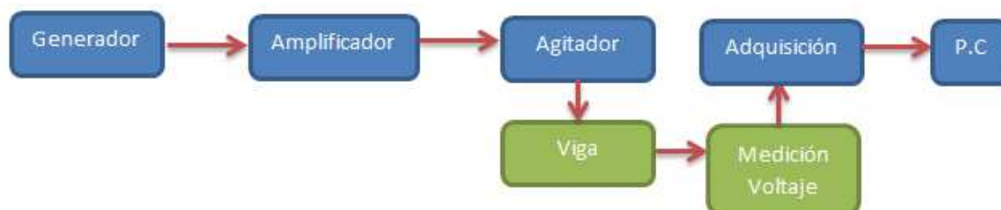
Figura 7.1: Diagrama de bloques de los equipos que componen el montaje experimental
