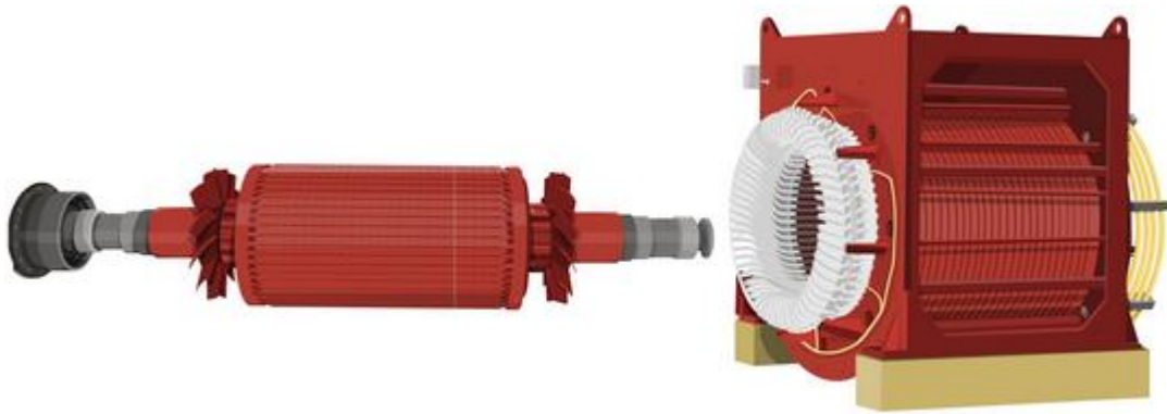
Figura 2.24: Izquierda: Rotor Cilíndrico y Derecha: Estator del Generador Cilíndrico.
