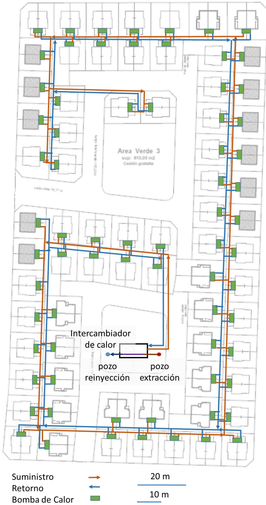
Figura 4-34: Red de distribución distrital de un módulo representativo del condominio. Fuente: Elaboración propia.
