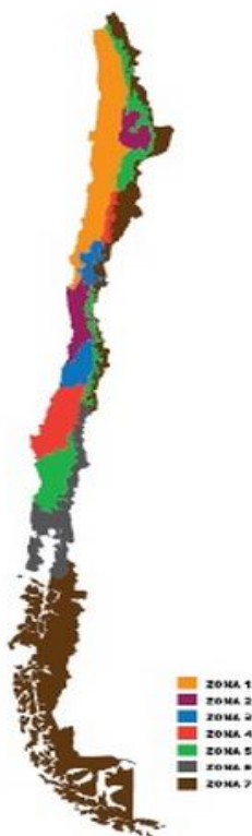
Figura 2.9: Zonificación térmica según O.G.U.C. Fuente: Guía de diseño para la eficiencia energética en la vivienda social, Waldo Bustamante G., 2009.
