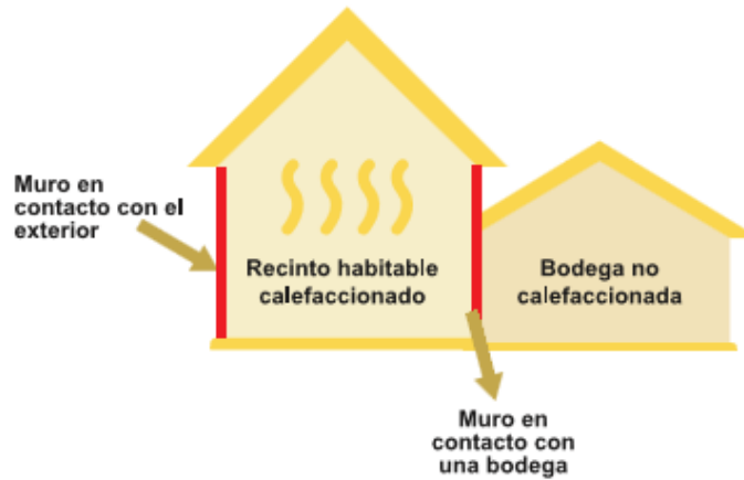
Figura 2.13: Tipos de muro para determinar resistencias superficiales
