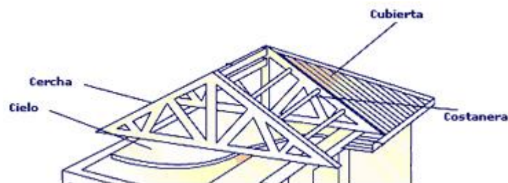
Figura 4.8: Esquema de los elementos de la techumbre
