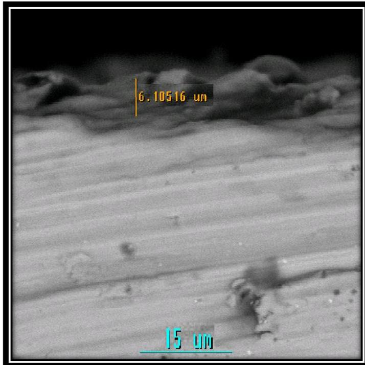
**Figura 82 :** Micrografía SEM que detalla el espesor medido del codepósito resultante del experimento E2 (ver Tabla 10).
