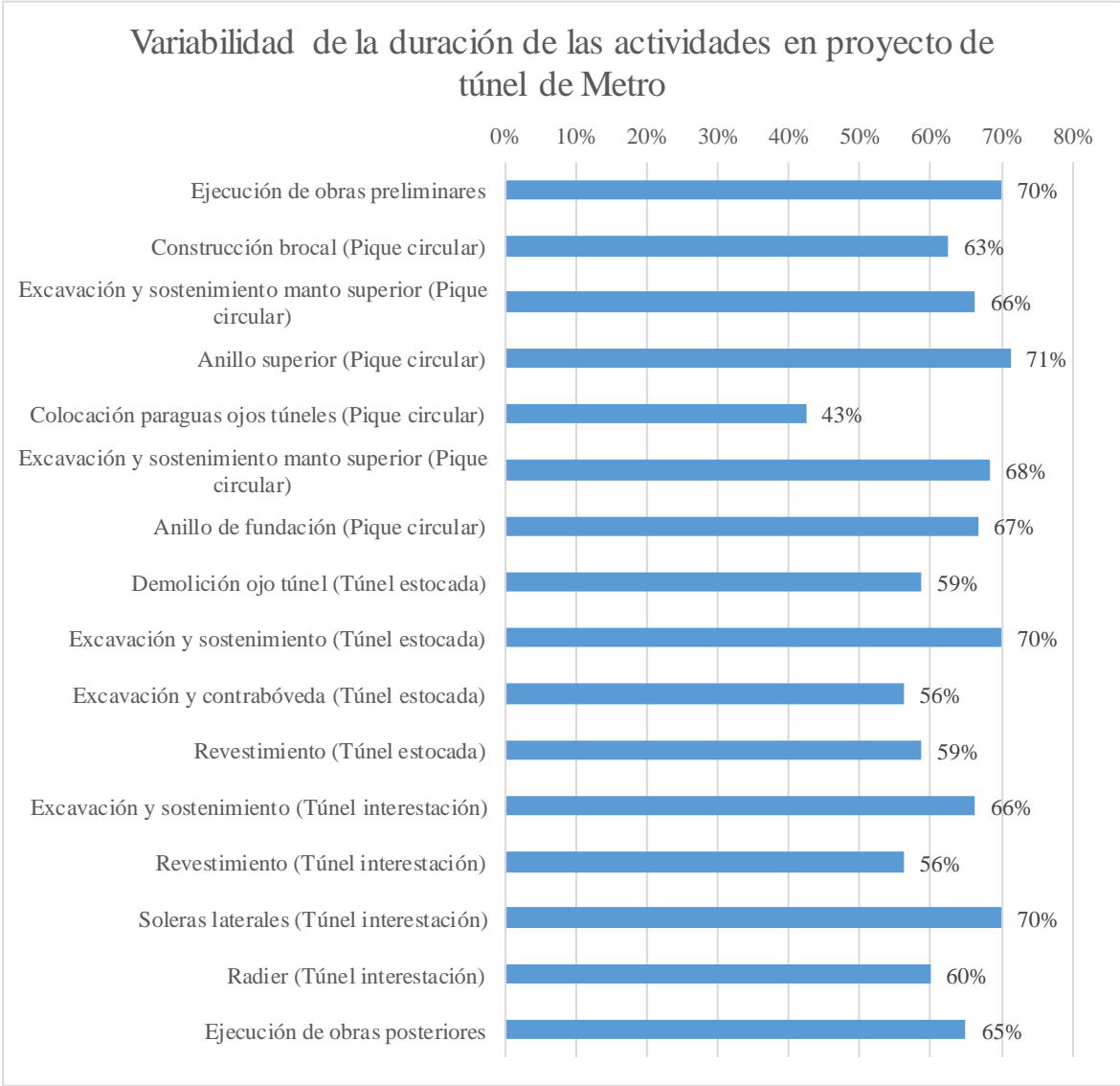
Figura 41: Variabilidad de la duración de las actividades en Proyectos de Túnel de Metro Fuente: Elaboración propia
