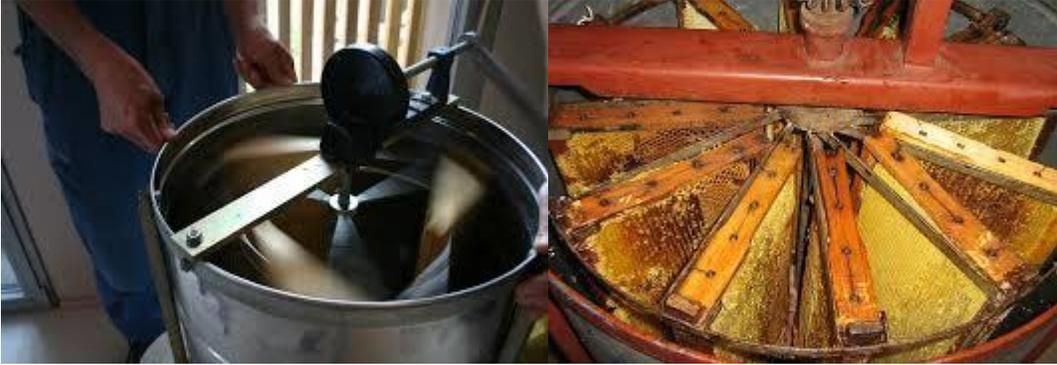
El extractor es un recipiente cilíndrico de capacidad variable, sobre cuyo eje se coloca una canastilla en la que se depositan los bastidores desoperculados para extraer la miel por fuerza centrífuga. Puede ser accionado por energía eléctrica o en forma manual.
