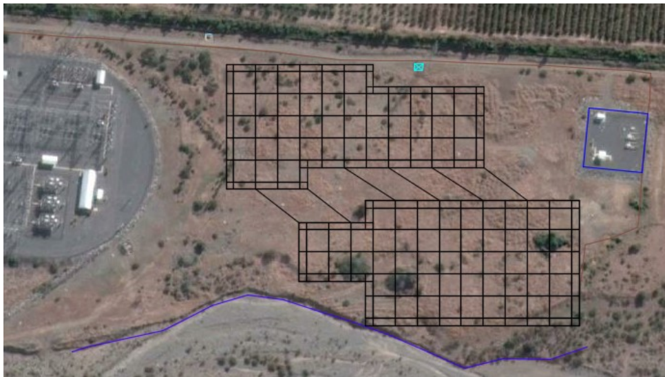
Figura 4.14: Malla de Puesta de Tierra
