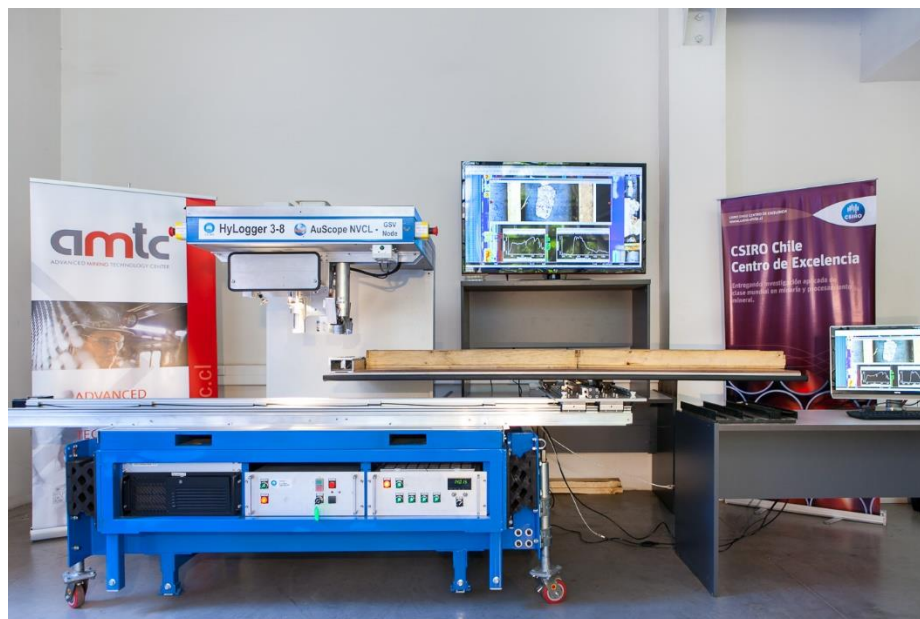
FIGURA 49: HYLOGGER INSTALADO EN EL AMTC DE LA UNIVERSIDAD DE CHILE.
