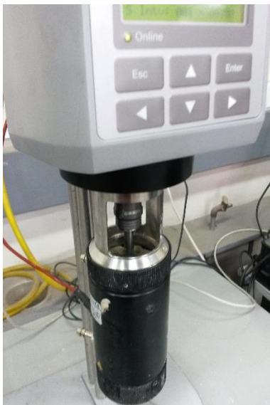
FIGURA 62: REOMETRÍA EN PROCESO.
