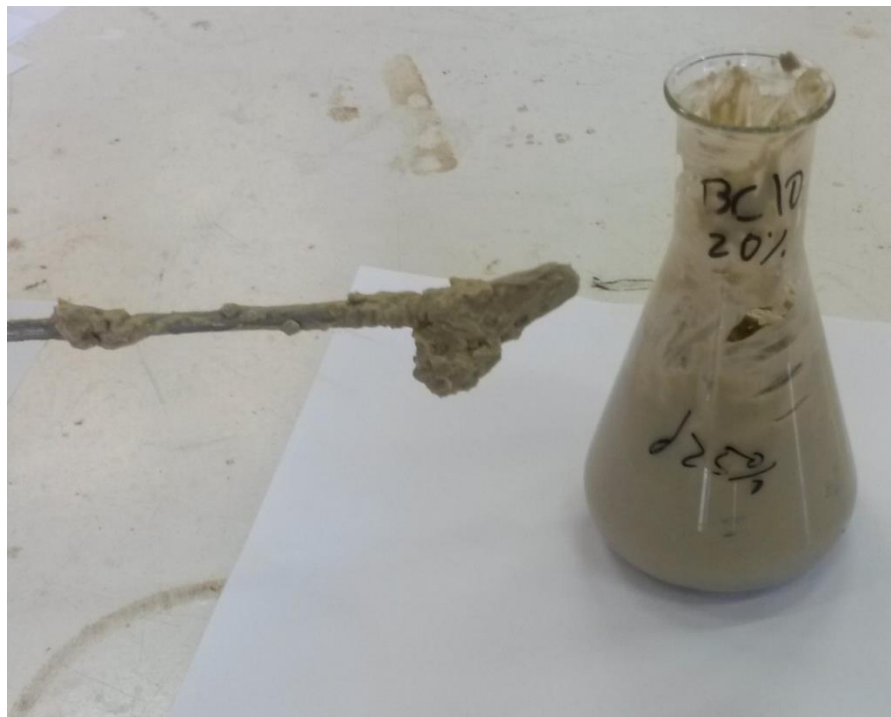
FIGURA 71: PRUEBA PRELIMINAR CON BENTONITA COMACSA, Cv20%.
