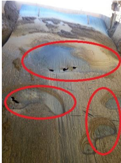
Figura 5.3: Zonas de desgaste en goma de impacto. [Fuente: Foto tomada por el autor.]
