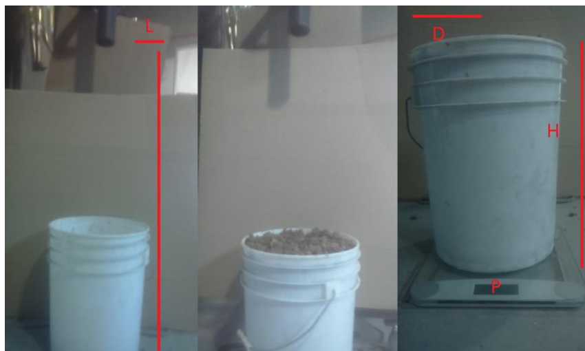
Figura 5.20: Ensayo de densidad sin compactar. [Fuente: Foto tomada por el autor.]
