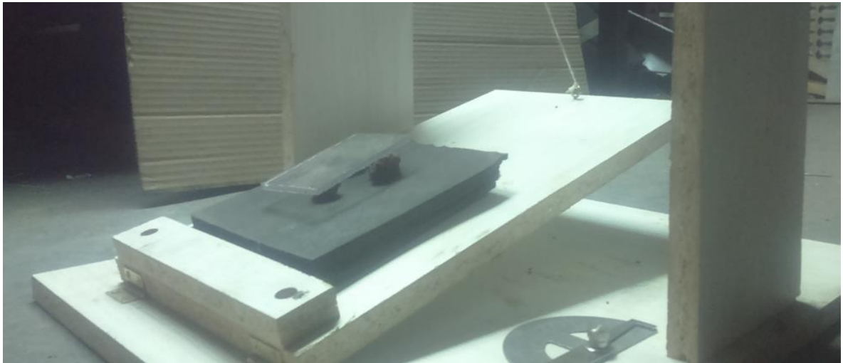
Figura 5.18: Montaje del ensayo de plano inclinado para estimar el coeficiente de roce estático. [Fuente: Foto tomada por el autor.]
