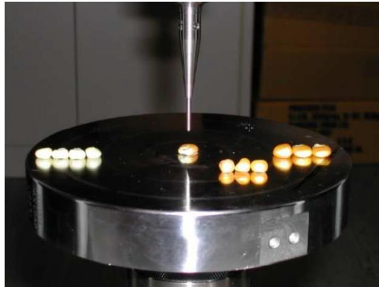
Figura 2.11: Ensayo de indentador esférico sobre granos de maíz. [Fuente: Johnstone, 2010.]
