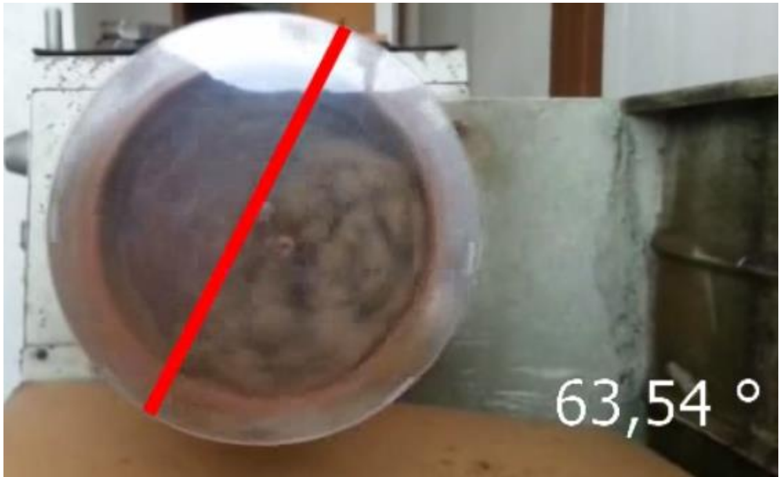
Figura 5.27: Ensayo experimental del ángulo de reposo dinámico. [Fuente: Foto tomada por el autor.]
