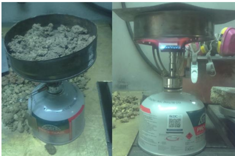
Figura 5.11: Ensayo de humedad, en la imagen se muestra el momento en que se calienta el material para evaporar la humedad.
