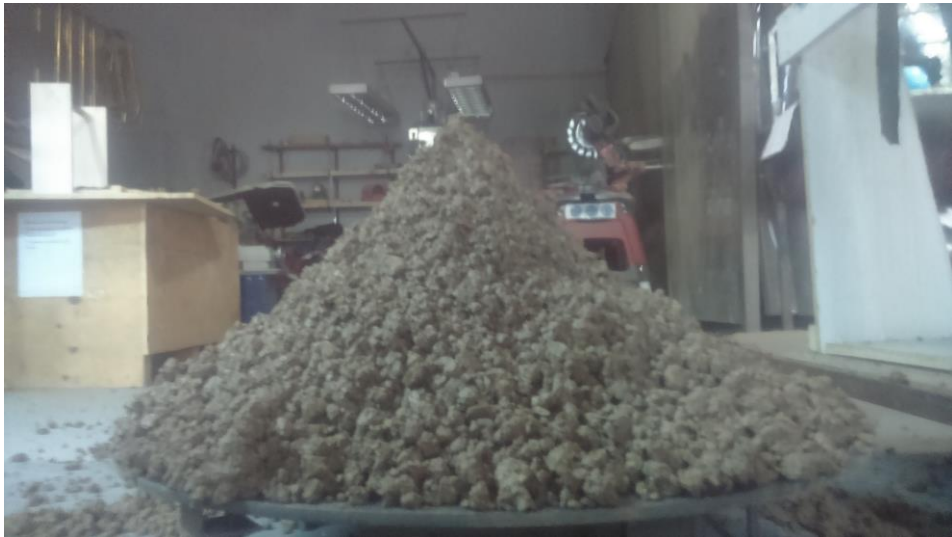
Figura 5.22: Ángulo de reposo obtenido experimentalmente con la humedad nominal del material. [Fuente: Foto tomada por el autor.]
