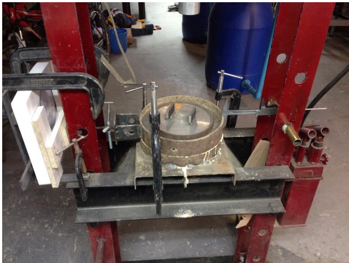
Figura 5.19: Montaje DST con fuerza normal ejercida por la tapa. [Fuente: Foto tomada por el autor.]
