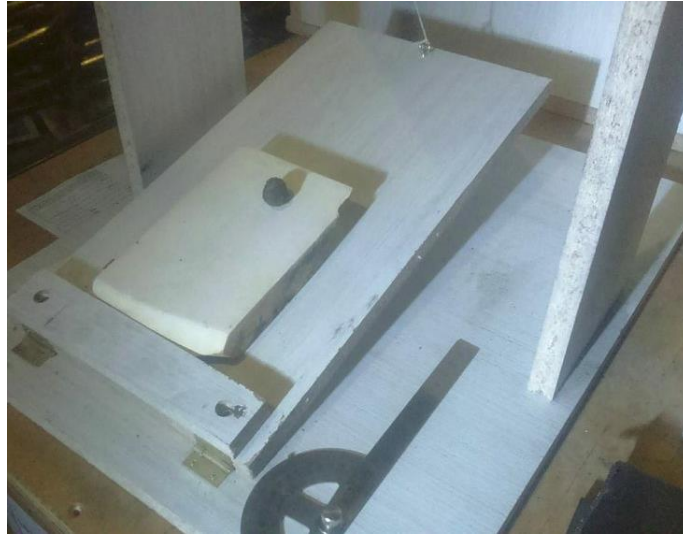
Figura 5.17: Montaje del ensayo de plano inclinado para estimar el coeficiente de roce de rodadura. [Fuente: Foto tomada por el autor.]
