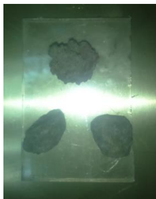
Figura 5.16: Muestra utilizada en el ensayo de plano inclinado para el cálculo del coeficiente de roce estático.
