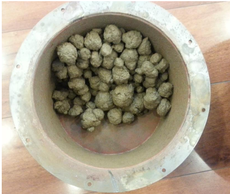
Figura 5.13: Material después de ser agitado en el molino. [Fuente: Elaboración propia.]
