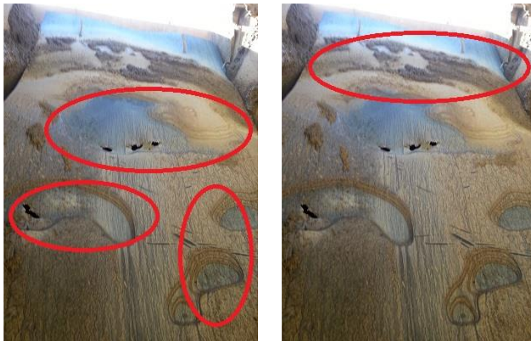
Figura 5.29 Goma de impacto, a la izquierda se presentan (encerrados con color rojo) las zonas de desgaste, mientras que a la derecha se muestra el material adherido.
