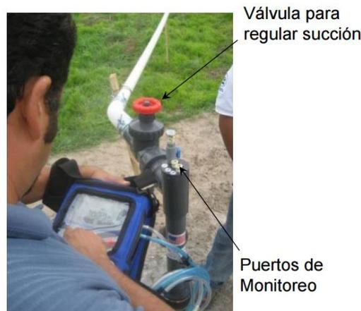
**Figura 2.8** Cabezal de pozo de extracción.
