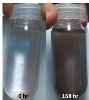
Fotografía 13: Fotografía comparativa del color de la suspensión de las partículas Cu3 al comienzo del ensayo y después de 168 horas.
