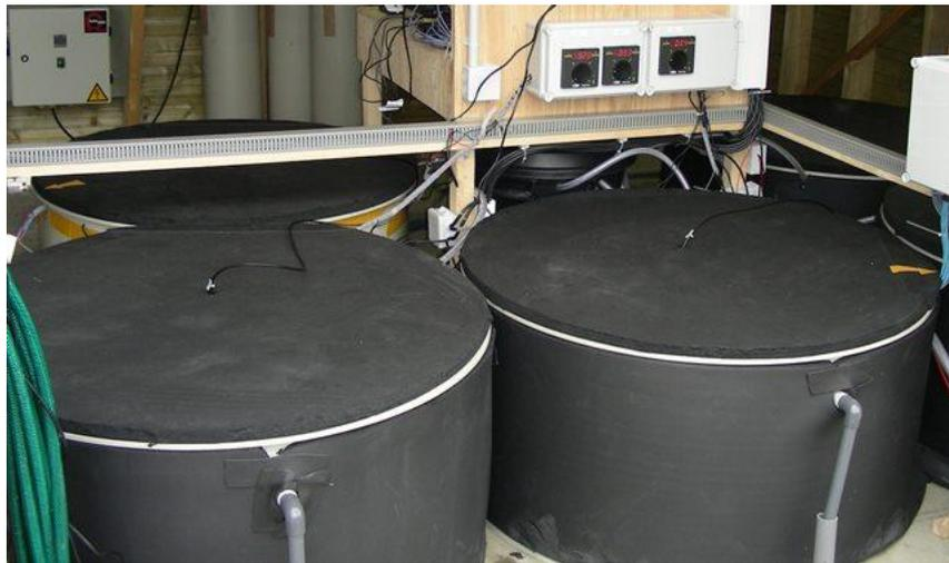
**Fotografía 1: Estanques de 220 l con recirculación utilizados para el crecimiento del fouling. Uno de estos estanques fue utilizado para ensayar todas las muestras. Los estanques mantienen la temperatura del agua entre 10 y 12 C, las muestras se mantienen en la oscuridad.**
