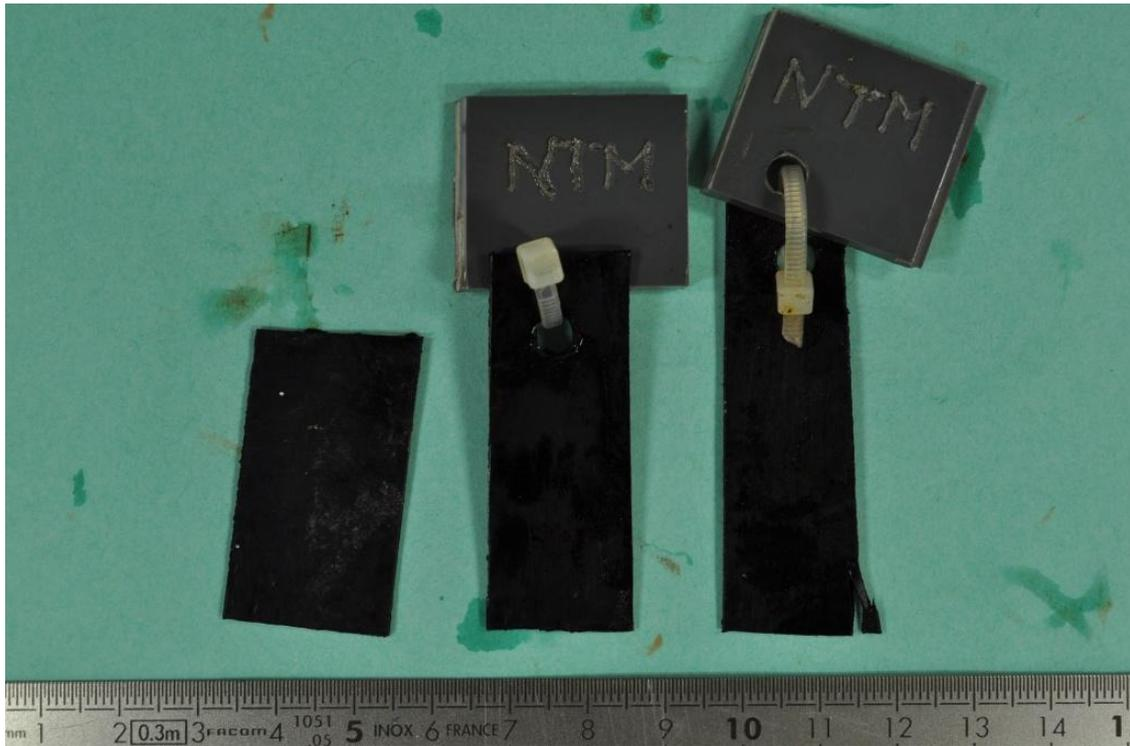
Fotografía 20: Muestra de mezcla HDPE+NTM, después del tiempo de exposición de dos meses en el estanque de recirculación. Sobre la superficie de la muestra se observa una opalescencia blanca.
