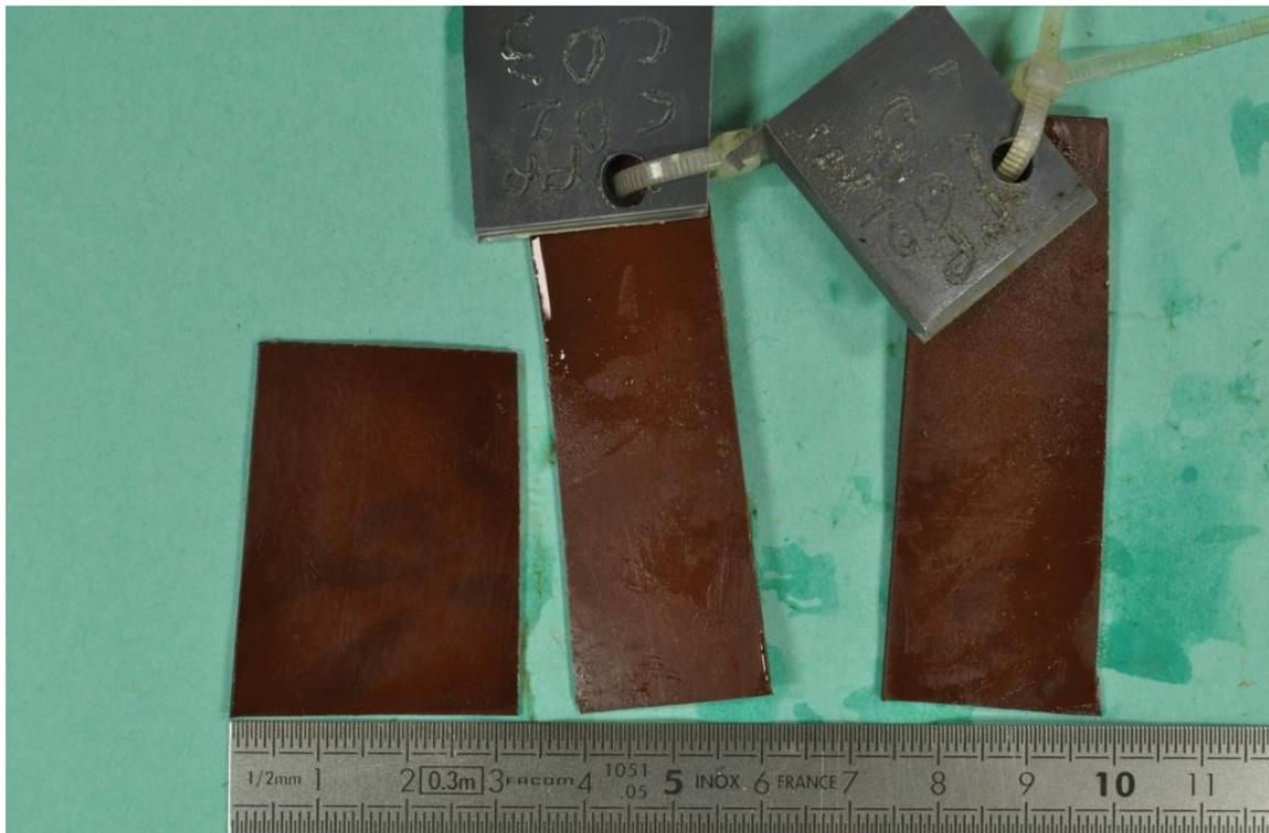
Fotografía 23: Muestra de la mezcla HDPE+Cu<sub>2</sub>+Cu<sub>3</sub>, después del tiempo de exposición de dos meses en el estanque de recirculación. Sobre la superficie de la muestra se observa una opalescencia blanca.
