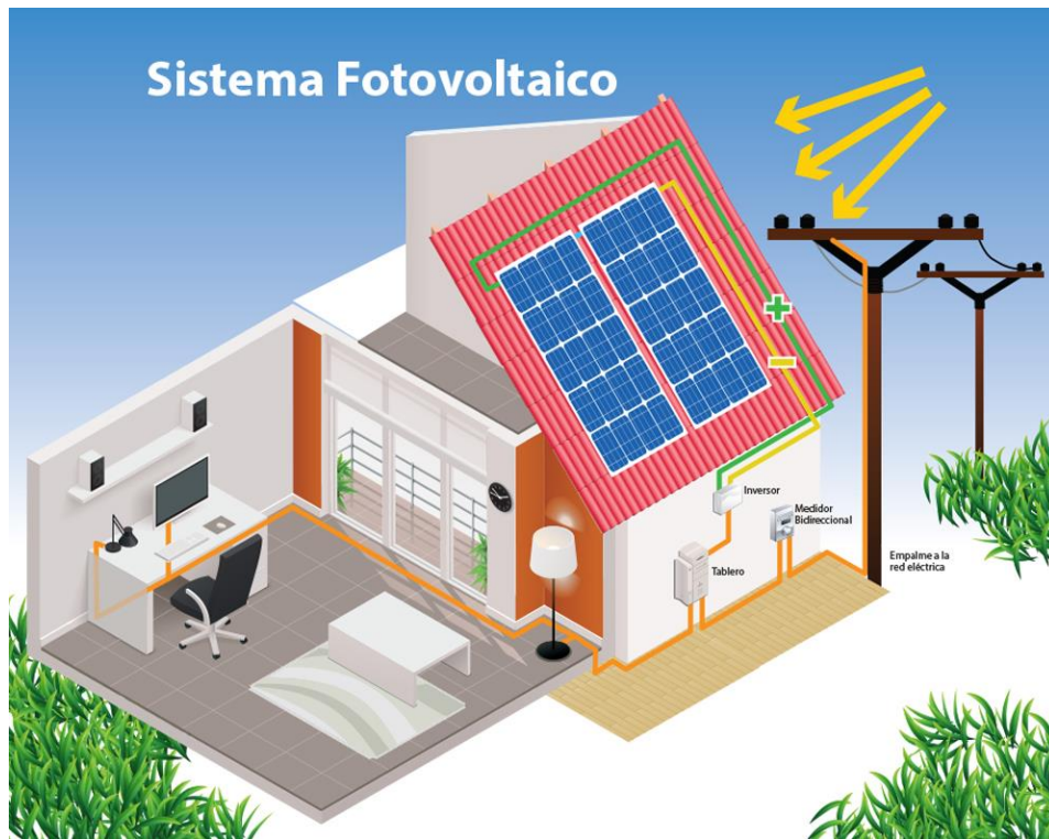
Figura 2.18: Instalación típica de un sistema fotovoltaico residencial. Fuente [31]
