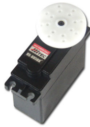
Figura 3.3. Servomotor que controla la expulsión de sedimento fino de la tolva.
