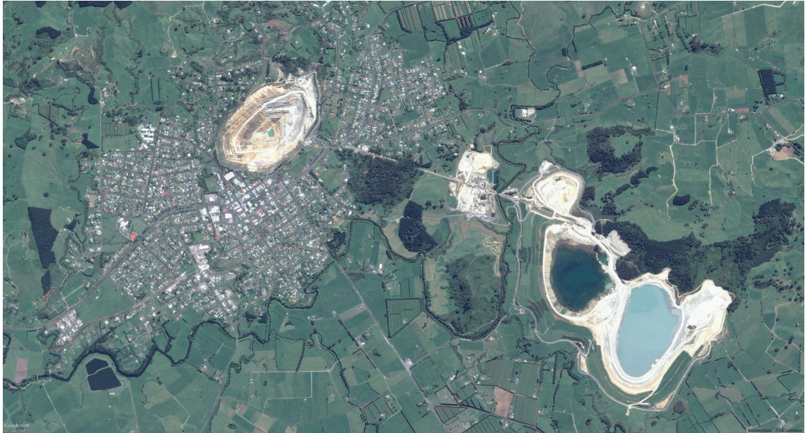
Fig. 18: Imagen satelital de la Mina Martha. Se aprecia la ciudad de Waihi colindando con el rajo de la mina. En el extremo inferior derecho, los diques de colas ya su alrededor los botaderos, algunos ya restaurados. Fuente: Google Earth, 2016
