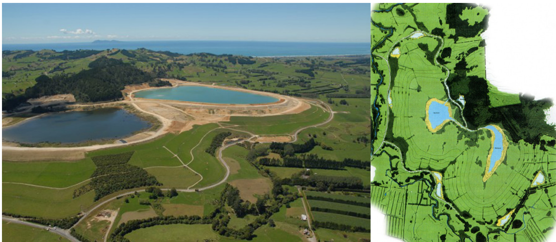
Fig. 19: Rehabilitación progresiva de los tranques de relaves para uso productivo. Fuente: www.waihigold.co.nz y www.straterra.co.nz
