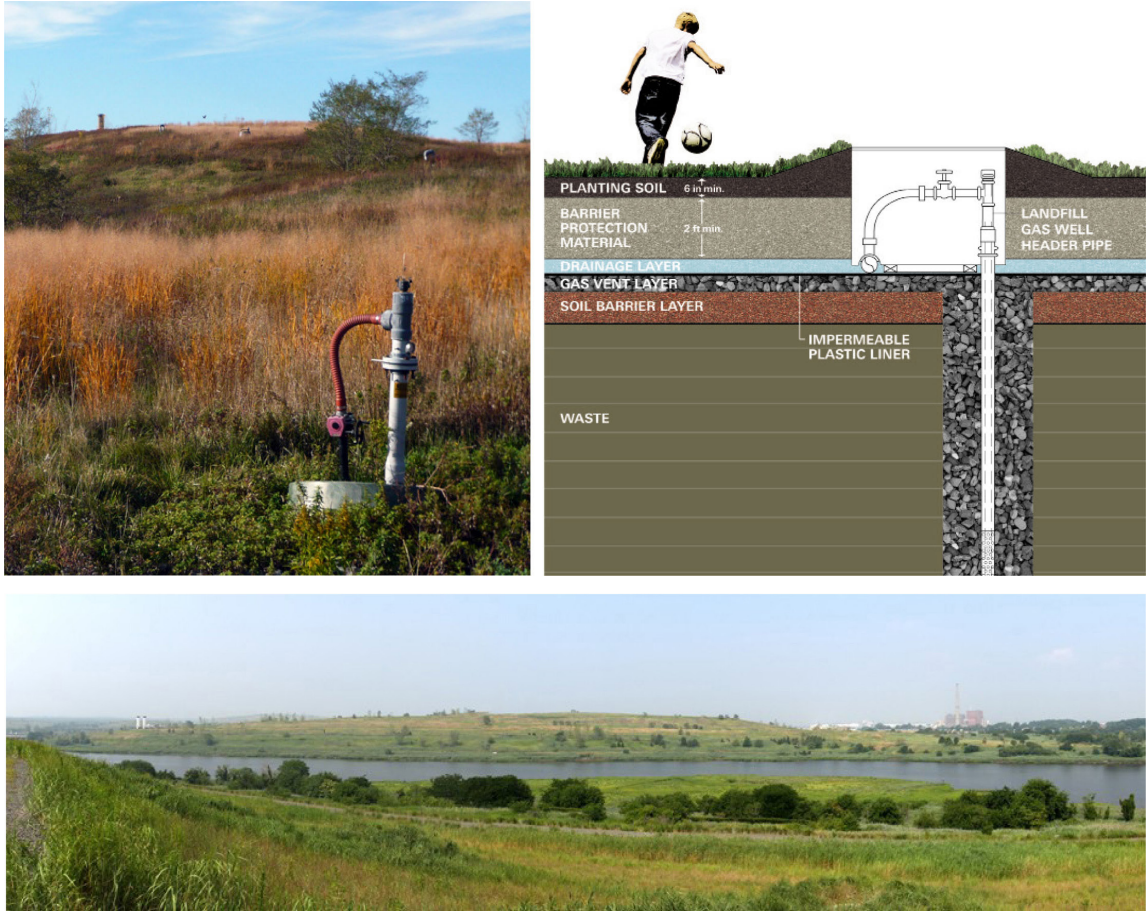
Fig. 14: Manejo de gases y tapado de los montículos: a la izquierda, una de las llaves de registro de biogás; a la derecha, las capas de sellado y la llave proyectada. Abajo, se divisa a la izquierda la estación de gas. Fuente: Freshkills Park Friends
