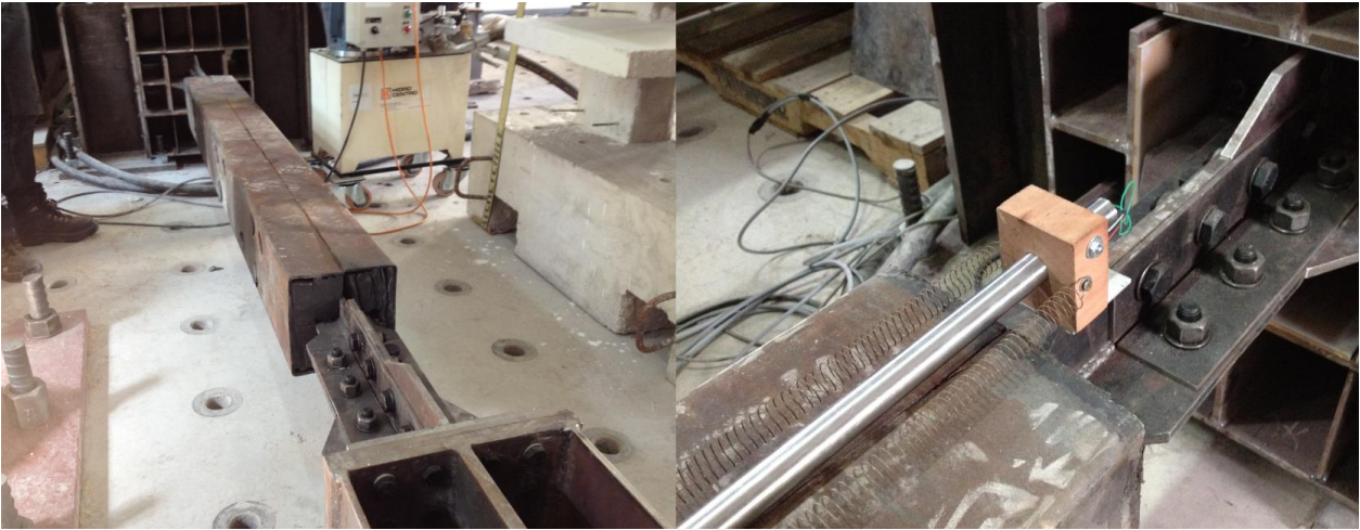
Figura 6. 4 Probeta durante el ensayo y soporte de LVDT.
