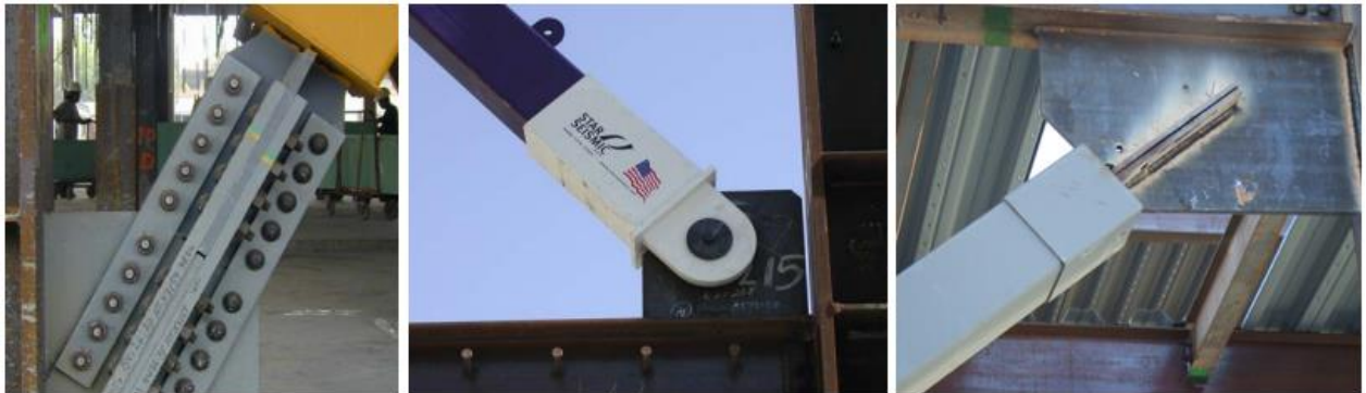
Figura 2. 16 Conexión apernada, rotulada y soldada para BRB.
