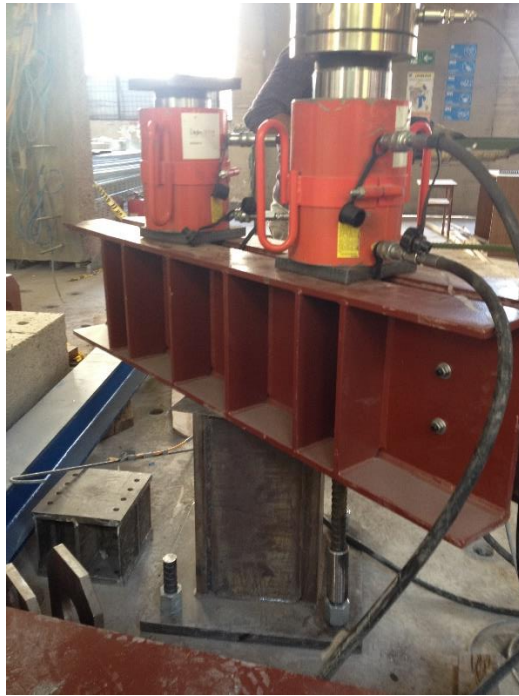
Figura 6. 1 Post tensado de barras de anclaje.
