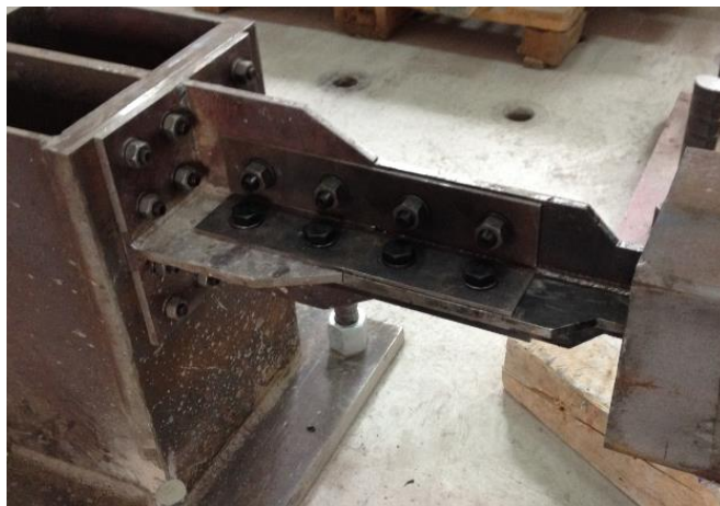
Figura 6. 2 Detalle de uniones apernadas.
