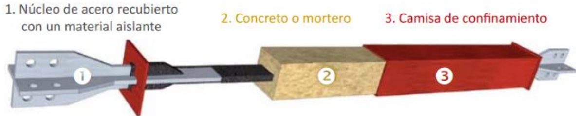
Figura 1. 1 Elementos que componen una riostra de pandeo restringido.
