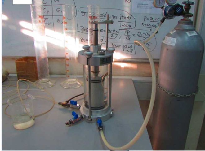
Figura 4. 4: Probeta sellada al vacío en cámara triaxial, durante paso de CO 2
