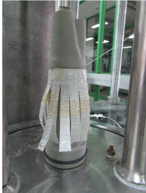
Figura 4. 6: Confección de probeta de altas presiones con falda de saco para evitar punzonamiento
