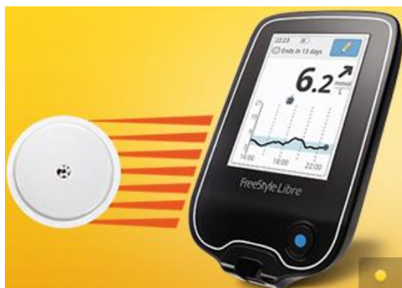
Ilustración 14: Biosensor que mide glucosa Intersticial
