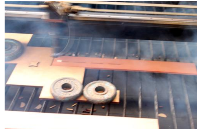
IMAGEN 34. PROCESO DE CORTE LÁSER
