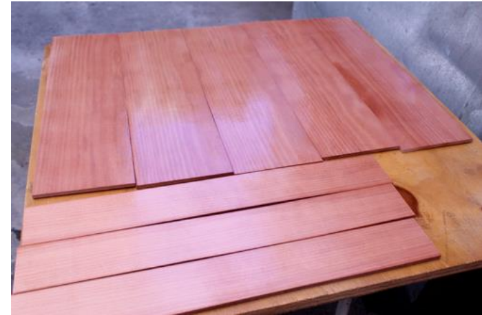
IMAGEN 33. LÁMINAS APLICADAS DE LACA SELLADORA
