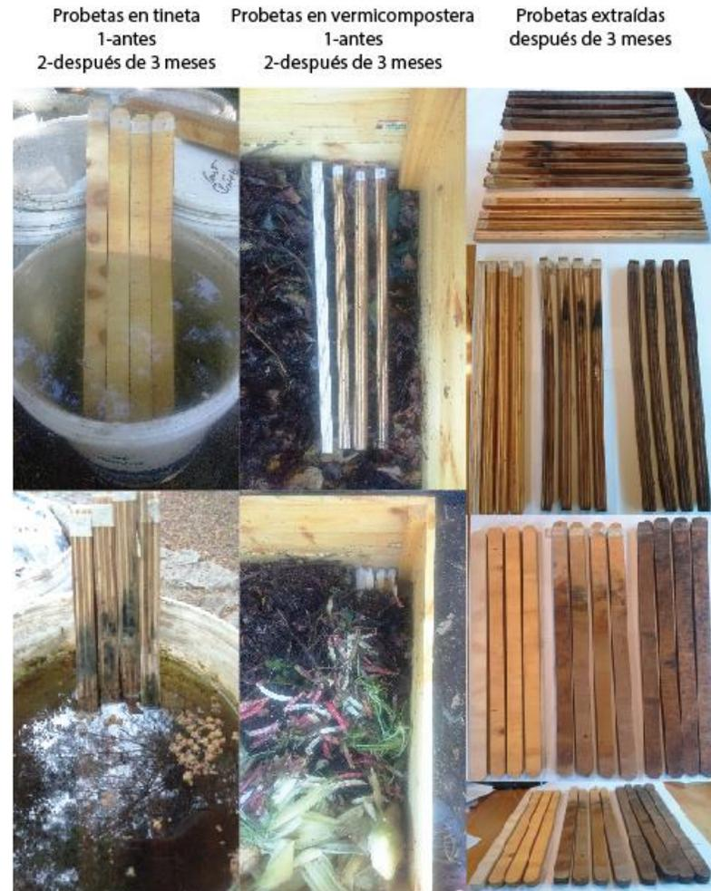
Imagen 9: Pruebas en tinetas y vermicompostera. Fuente: Elaboración propia.
