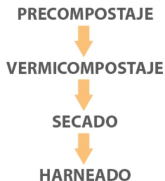
Figura 10: Etapas del proceso del vermicompostaje. Fuente: Elaboración Propia.
