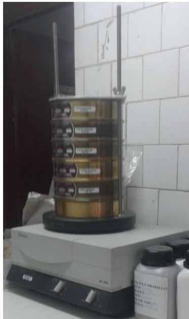
***Figura 3: Tamiz eléctrico utilizado para determinar granulometría de la materia prima utilizada en la elaboración de leche de avena.***
