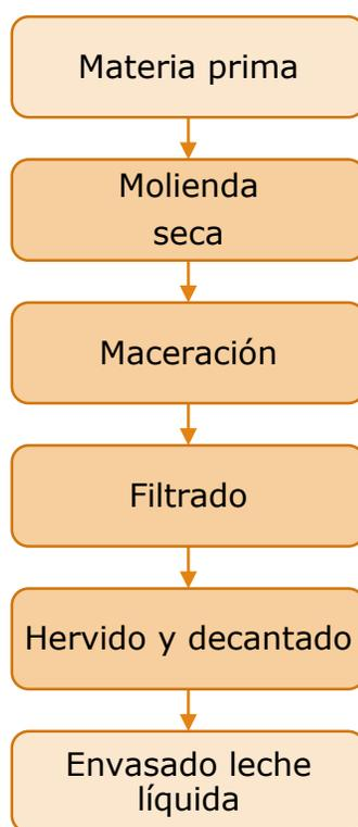
**Figura 4.1: Proceso de elaboración de leche de avena a implementar según la adaptación realizada.**
