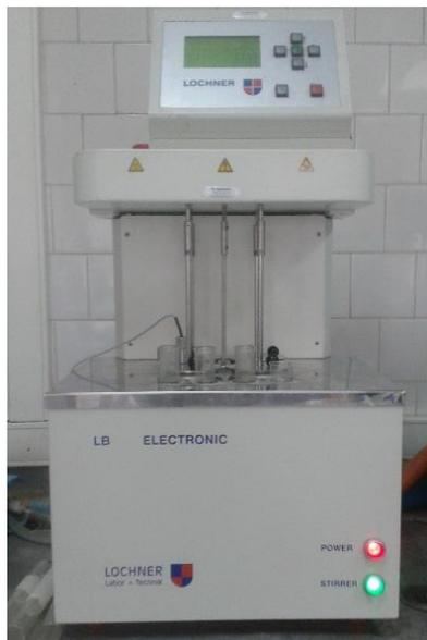
**Figura 3.5: Macerador de laboratorio marca LB Electronic, modelo LB 4, utilizado durante la fase experimental.**
