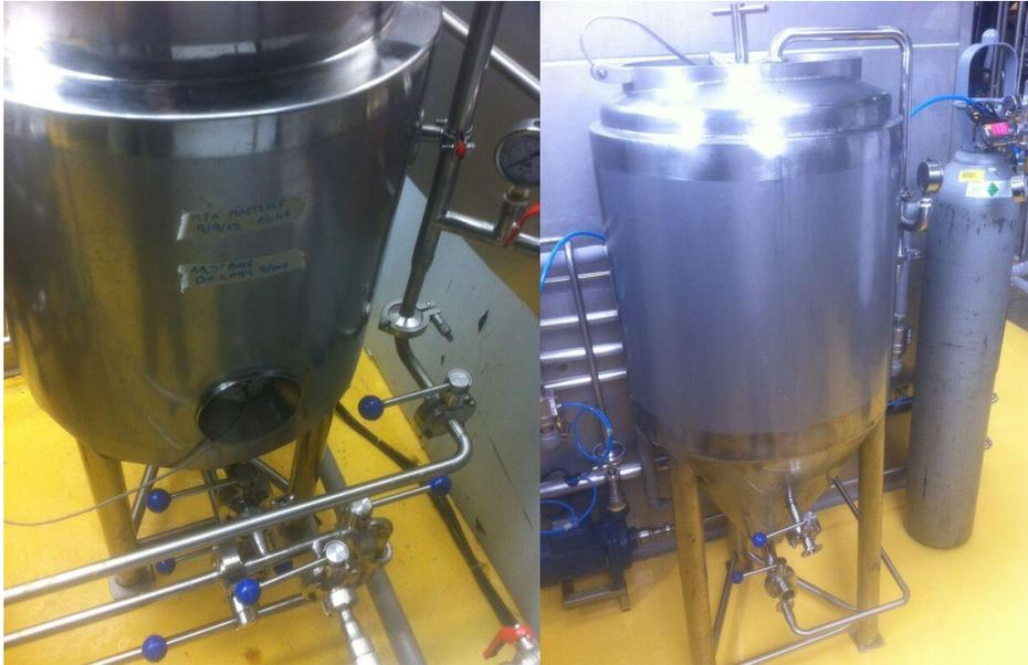
**Figura 2.9: Fermentador (izquierda) y gasificador (derecha) de la planta piloto.**
