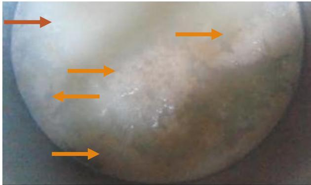
**Figura 4.7: Vista superior del interior del Whirlpool tras 1 hora de operación. La flecha roja indica las zonas de baja concentración de sólidos aglomerados. Las flechas naranjas indican las zonas de alta concentración de sólidos aglomerados.**
