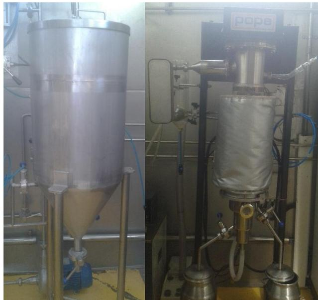
**Figura 2.8: Decantador Whirlpool (izquierda) y concentrador marca POPE (derecha) de la planta piloto.**
