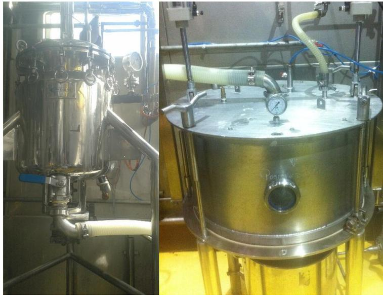
**Figura 2.7: Macerador (izquierda) y filtro vertical (derecha) de la planta piloto.**
