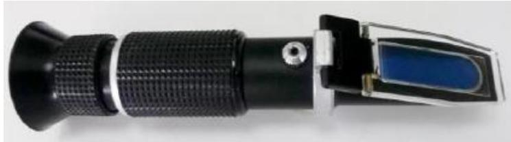
**Figura 4: Refractómetro utilizado para medir sólidos solubles.**
